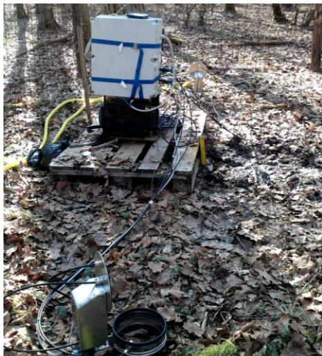
Slika 2.9. Sustav za izmjeru tok CO<sub>2</sub> iz tla postavljen u III dobnom razredu.
