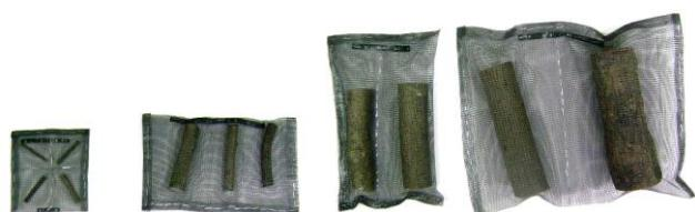
Slika 2.11. Vrećice za procjenu brzine razgradnje mrtvog drva za 4 dimenzije uzorka.
