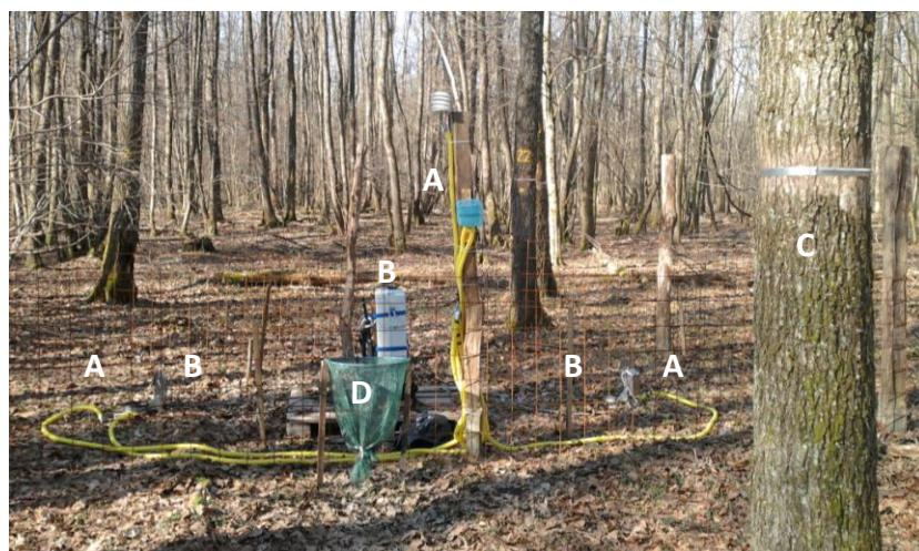
Slika 2.3. U potpunosti opremljena intenzivna ploha u III dobnom razredu. A – mini-meteorološka stanica i pripadajući senzori; B – sustav komora za izmjjeru respiracije tla; C – dendrometarska traka; D – košara za lišće.
