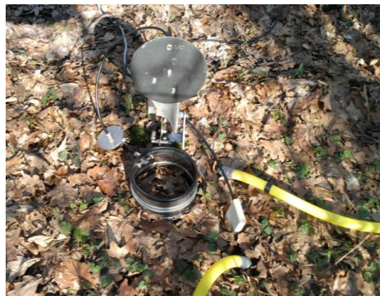
Slika 2.10. Komora postavljena neposredno uz senzore za vlagu i temperaturu tla mini-meteorološke stanice.
