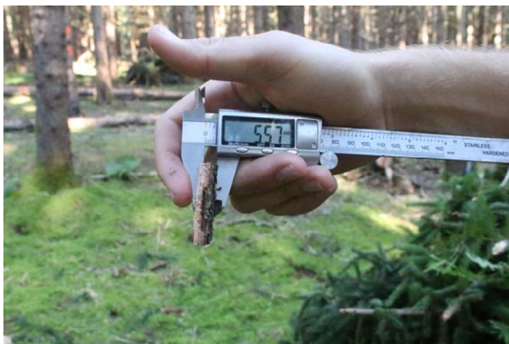
Slika 23. Debljina kore (mm) mjerena digitalnim pomičnim mjerilom
