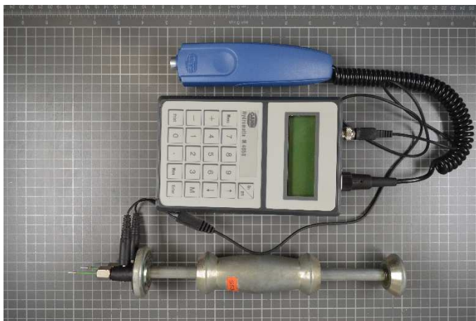
Slika 6. Elektrootporni vlagomjer GANN Hydromette M 4050.
