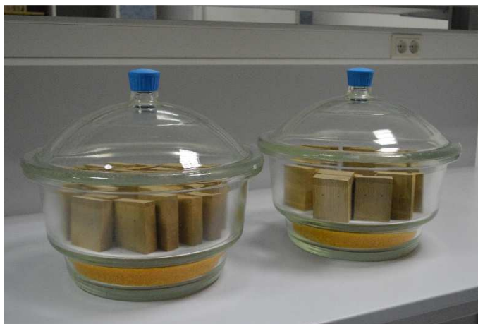
Slika 11. Hlađenje uzoraka u eksikatoru.
