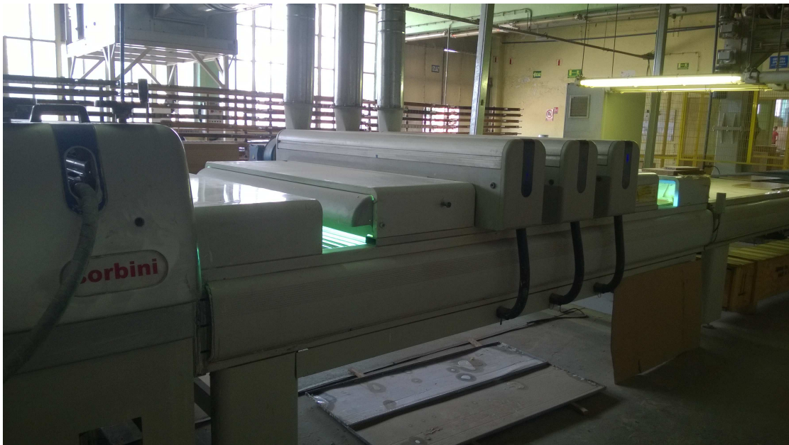
Slika 29. Dvostruki red UV lampi
