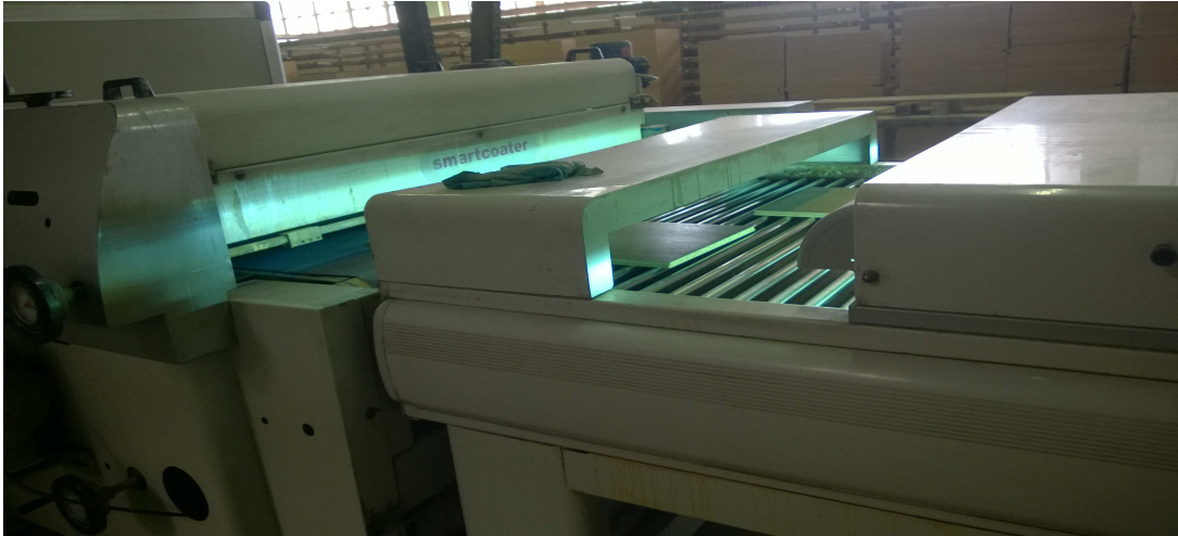
Slika 28. UV lampe za sušenje
