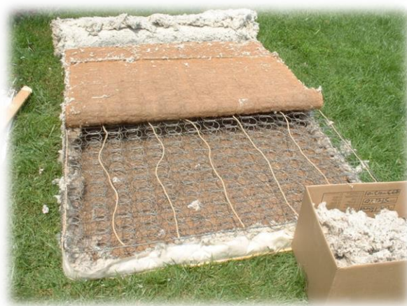
Slika 16. Opružna jezgra - primjer zastarjele konstrukcije madraca
