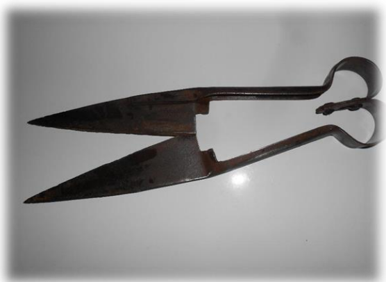
Slika 14. Ručne škare za strižu ovaca
