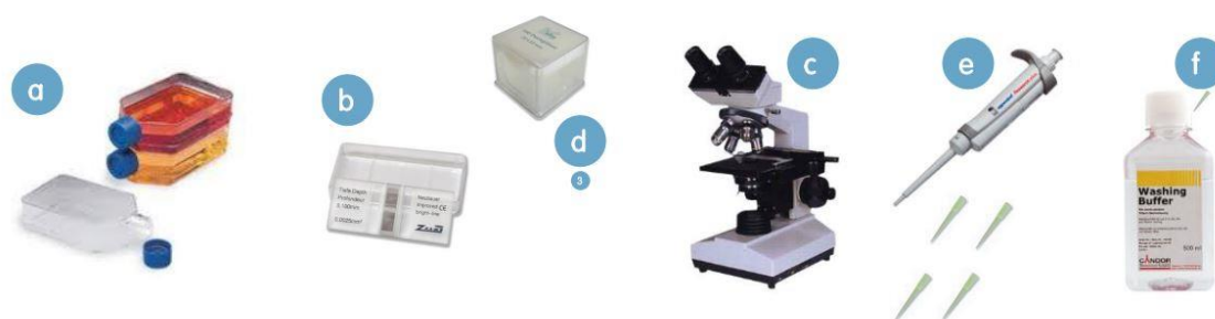
Slika 22. a) stanična otopina ili otopina spora; b) Hemocitometar, Neubauer komorica; c) svjetlosni mikroskop; d) pokrovna stakalca; e) pipeta i mikropipeta s jednokratnim vrhovima; f) pufer za razrjeđivanje (PBS)
