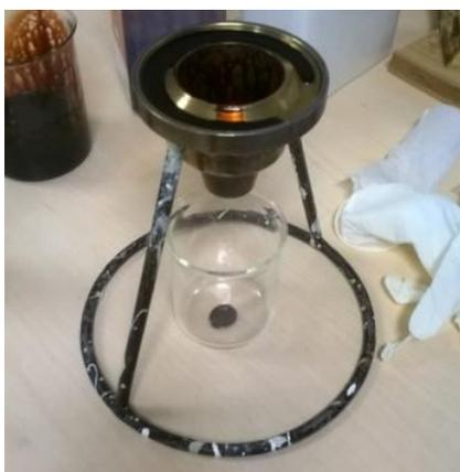
**Slika 4.** Viskozimetar
