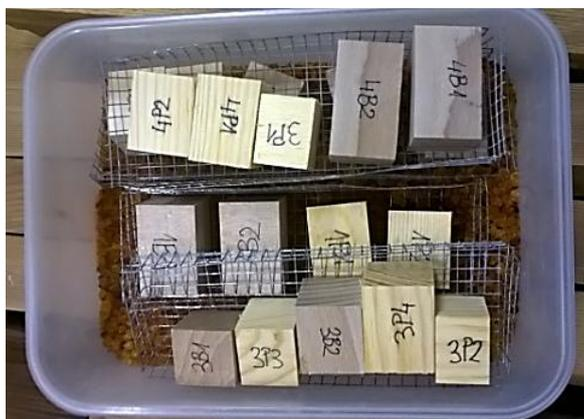
**Slika 2.** Kondicioniranje uzoraka
