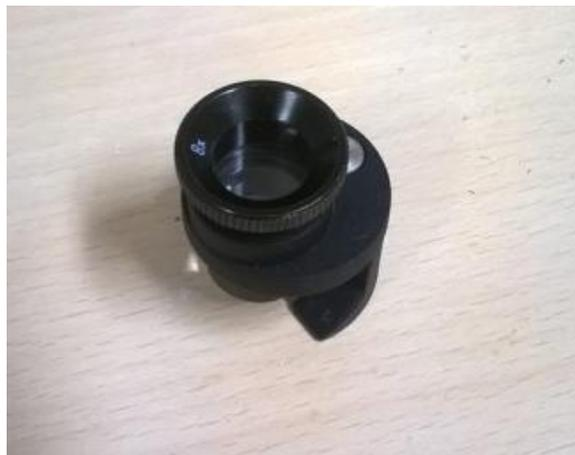
**Slika 9.** Lupa za mjerenje dubine penetracije
