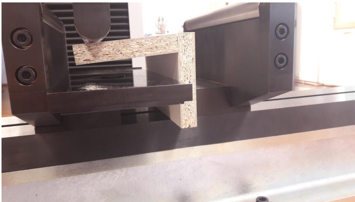
Slika 15. Uzorak za vrijeme ispitivanja u kidalici
