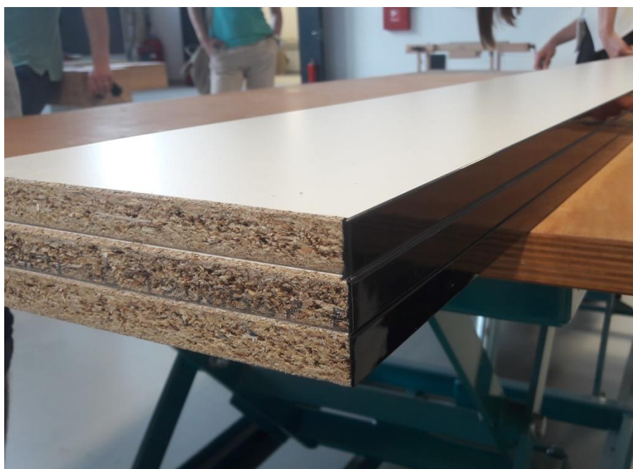
Slika 5. Troslojna iverica obložena ABS trakom
