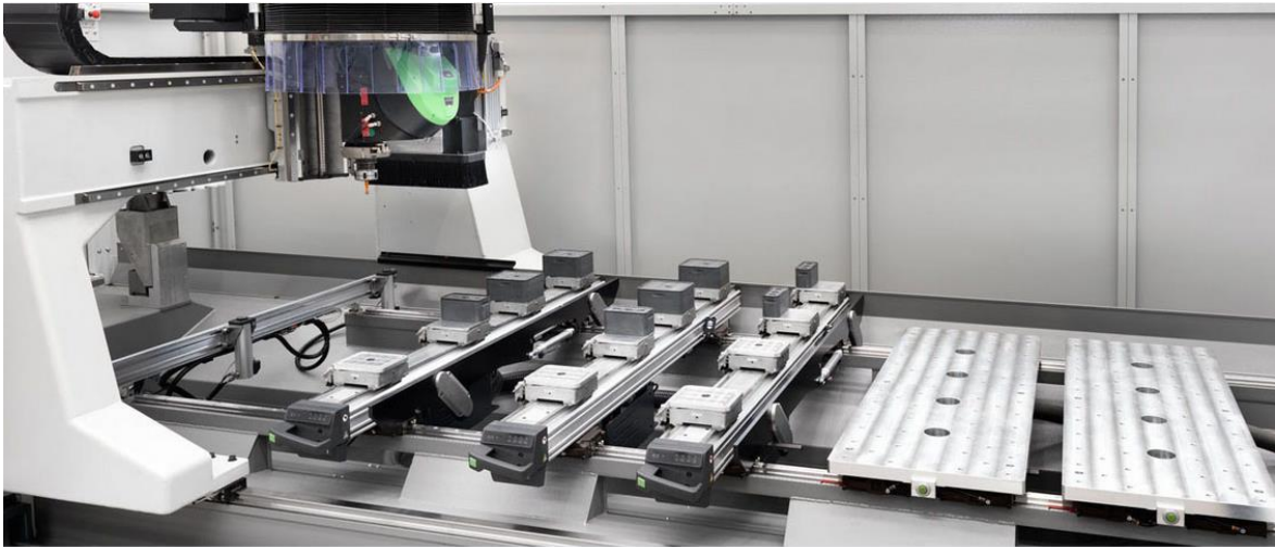
Slika 7. Radni stol Biesse Rover M5 sa postavljenim univerzalnim ravnim radnim stolom (UFT)
