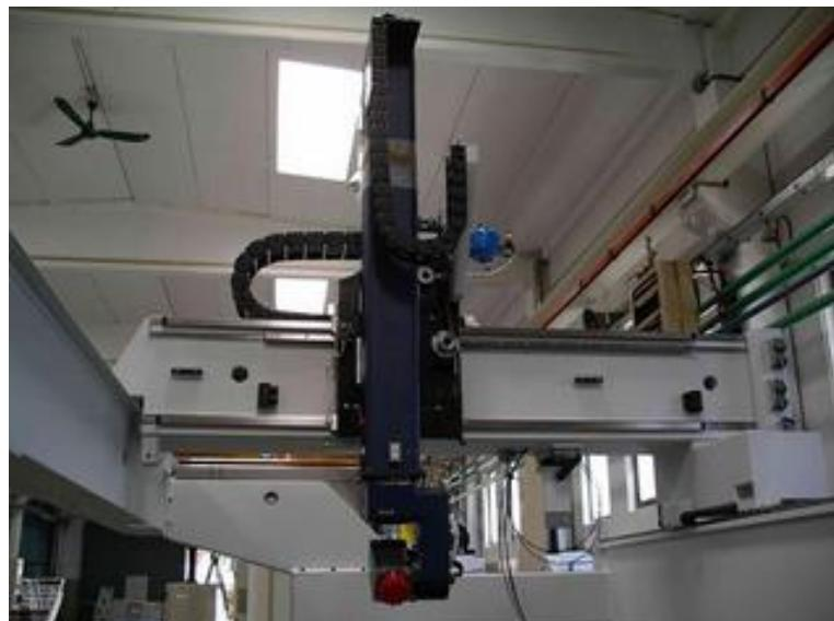
Slika 12. Pogled na dvostruki pomični most, jarbol koji omogućava kretanje po Z osi te radnu glavu CMS Aries CNC stroja
