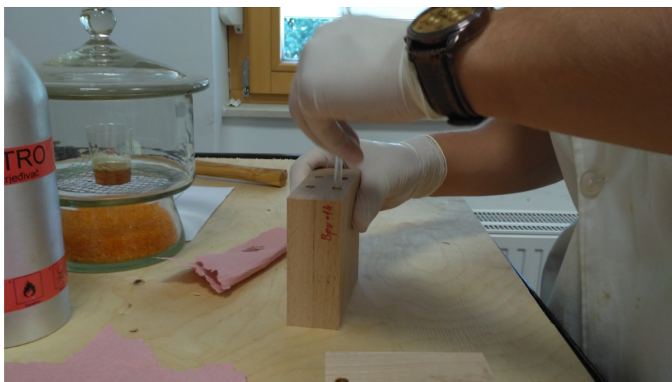
Slika 2. Razmazivanje ljepila u rupi
