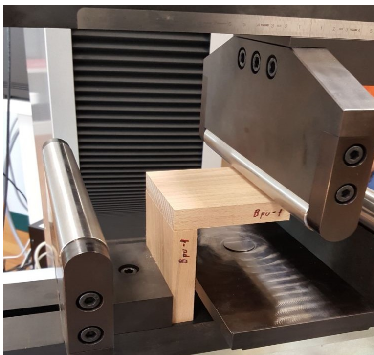
Slika 8. Položaj uzorka na kidalici
