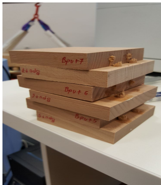
Slika 14. Potpuni lom moždanika s maksimalnom količinom nanosa ljepila
