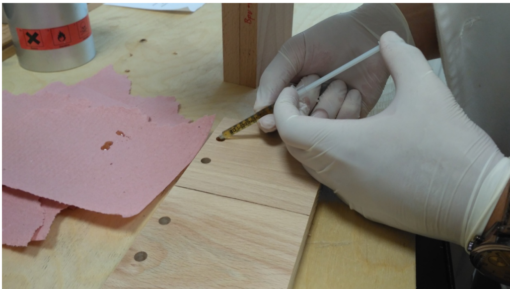
Slika 1. Nanošenje PUR ljepljiva
