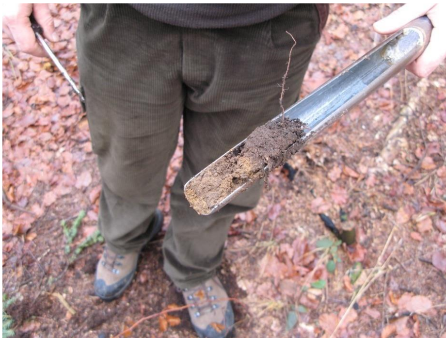
Slika 8. Uzorak tla uzet pedološkom sondom
