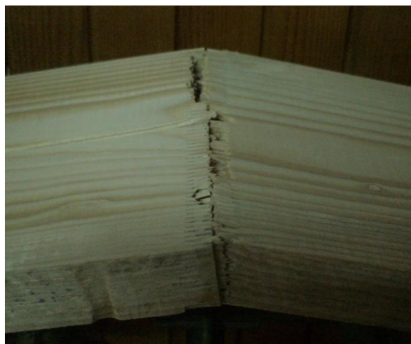
Slika 28. Izgled zupčastog spoja nakon ispitivanja
