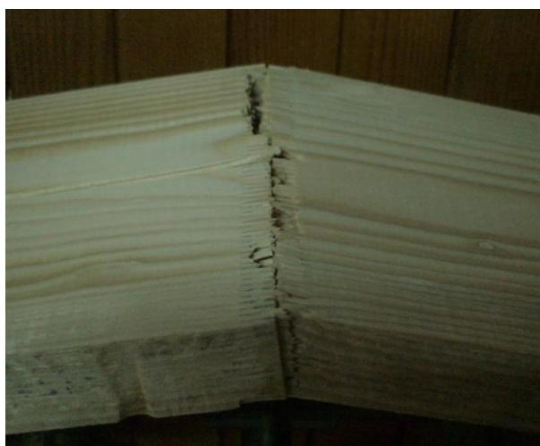
**Slika 28.** Izgled zupčastog spoja nakon ispitivanja
