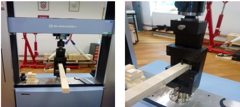
Slika 22. Ispitivanje čvrstoće na smik
