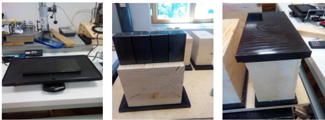
**Slika 20.** Faze pripreme uzorka za ispitivanje čvrstoće na vlak
