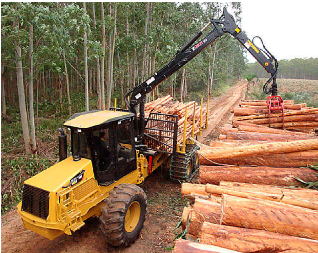
Slika 5. Forvarder Caterpillar prilikom istovara na pomoćnom stovarištu
