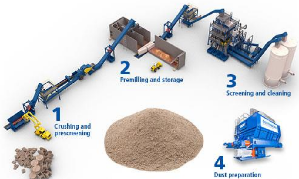
Slika 1. Pojednostavljeni prikaz recikliranja drva u sitnu sječku
