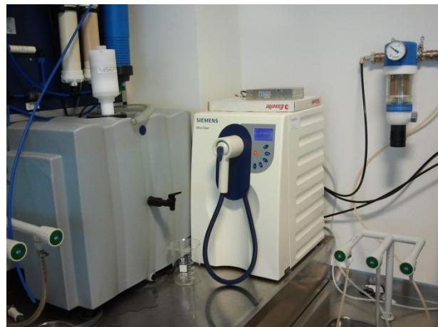
**Slika 3.** Uređaj za pripravu ultračiste vode Siemens Ultra clear
