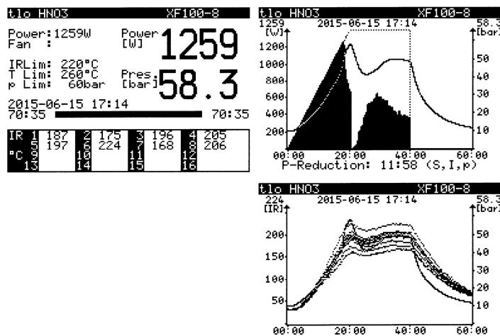
**Slika 10.** Ispis instrumentne metode za razaranje uzorka u mikrovalnom sustavu pri maksimalnoj temperaturi od 220 °C
