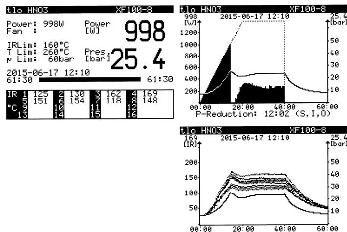
**Slika 7.** Ispis instrumentne metode za razaranje uzorka u mikrovalnom sustavu pri maksimalnoj temperaturi od 160 °C
