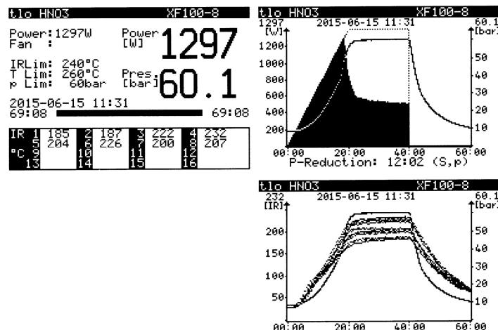
**Slika 11.** Ispis instrumentne metode za razaranje uzorka u mikrovalnom sustavu pri maksimalnoj temperaturi od 240 °C
