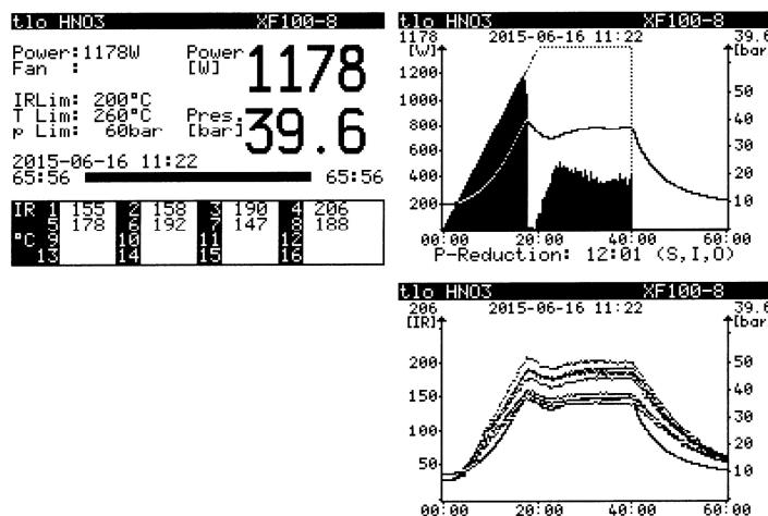
**Slika 9.** Ispis instrumentne metode za razaranje uzorka u mikrovalnom sustavu pri maksimalnoj temperaturi od 200 °C
