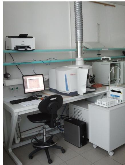
**Slika 5.** Spektrometar ICP-AES Thermo Fischer iCAP6300 Duo
