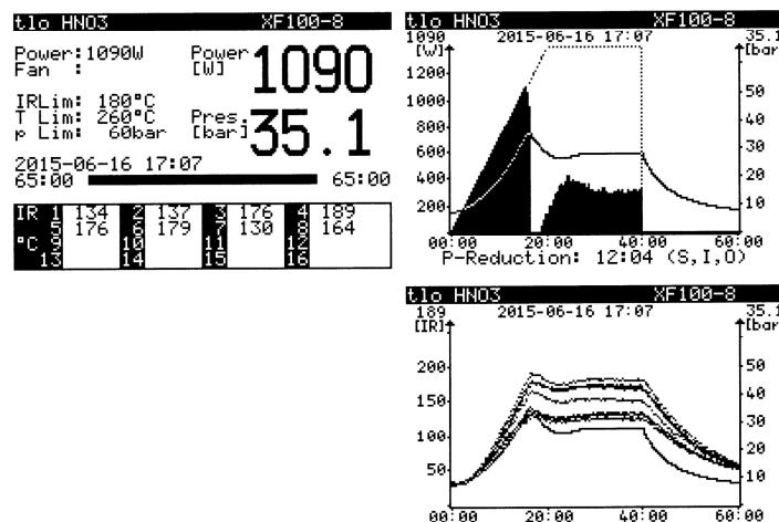
**Slika 8.** Ispis instrumentne metode za razaranje uzorka u mikrovalnom sustavu pri maksimalnoj temperaturi od 180 °C
