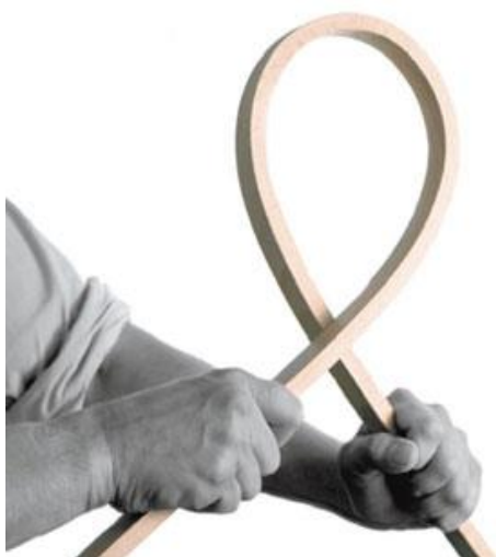
Slika 14. Savijanje materijala Bendywood ®
