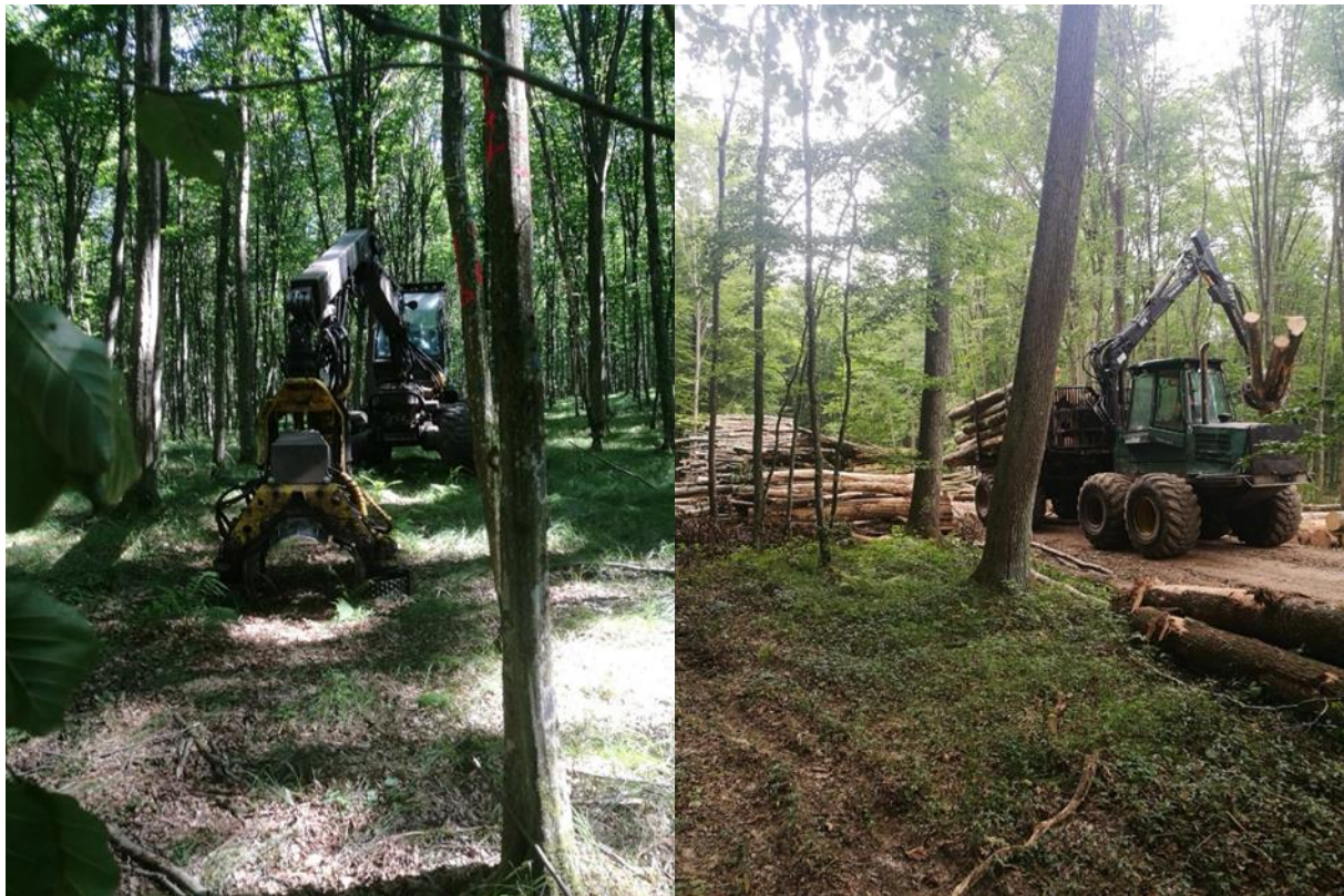
Slika 2. Skupni rad harvesterera i forvardera u prorednoj sječi listača
