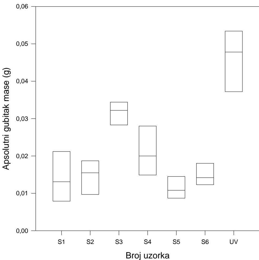
Slika 9: Apsolutni gubitak mase na potpuno potrošenom uzorku
