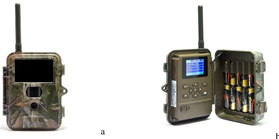
Slika 6. Izgled kamere Dörr SnapShot MOBIL Black 5.0 MP. a-vanjski izgled, b-unutarnji izgled s prostorom za baterije (desna strana kamere) te ekranom i dijelom za namještanje postavki (lijeva strana kamere)
