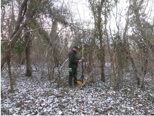
Slika 2- Primjer snimanja precizne koordinate za plohu 10
