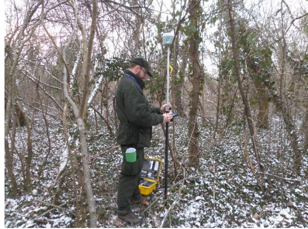
Slika 2- Primjer snimanja precizne koordinate za plohu 10 (bliži pogled)
