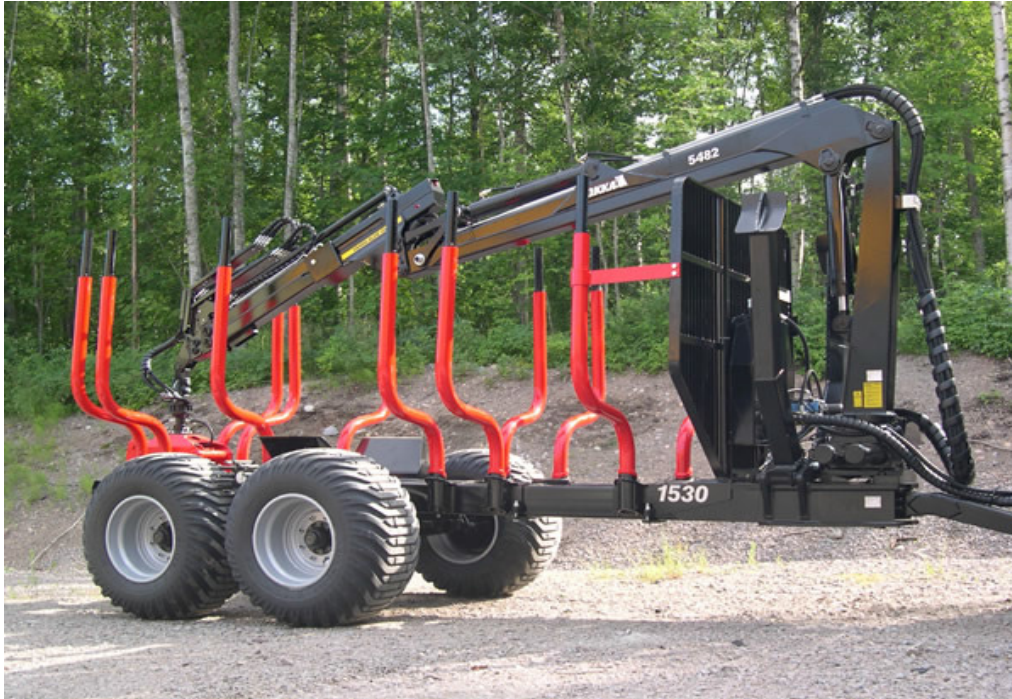
Slika 4. Šumska traktorska poluprikolica s dizalicom za prijevoz drvenih trupaca tvrtke Nokka
