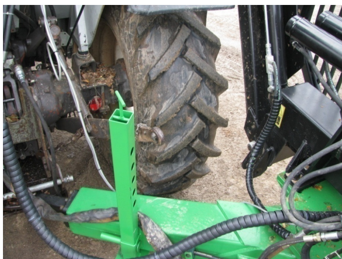
Slika 11. Zakretanje ruda pomoću horizontalnog zgloba
