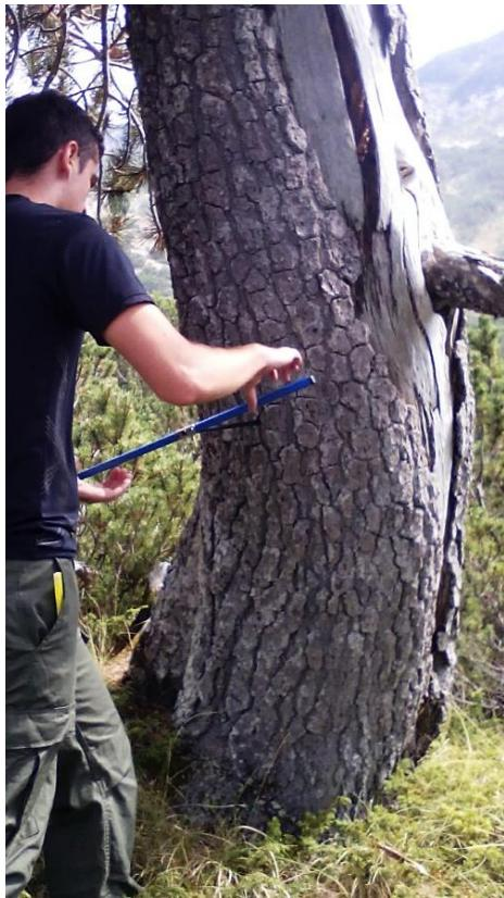
Slika 17. Postupak izvlačenja uzorka (Foto: Domagoj Trlin, 2017)
