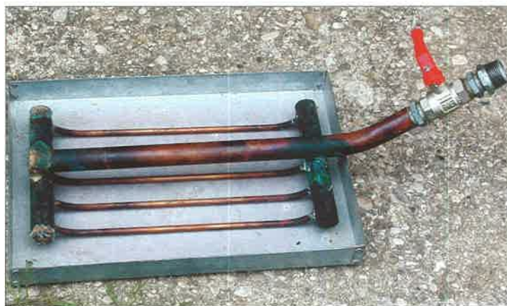
Slika 9. Inovativna naprava za sjetvu sjemena u kontejnere "Bosnaplast" Figure 9 Innovative device for sowing seeds in "Bosnaplast" containers
