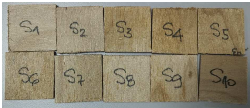
Slika 9. Uzorci WPC pripremljeni za ispitivanje fizikalnih svojstava
