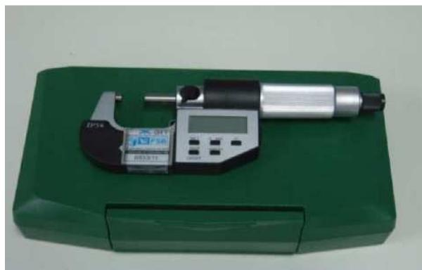
*Slika 11. Digitalni mikrometar*
