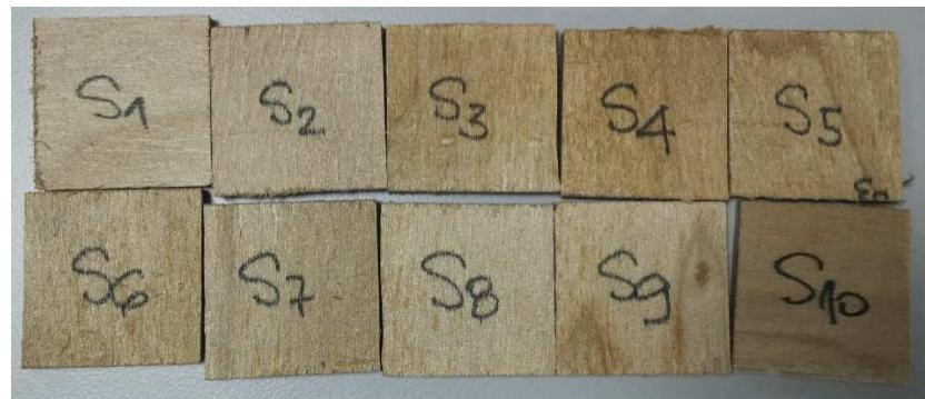
Slika 9. Uzorci WPC pripremljeni za ispitivanje fizičkih svojstava
