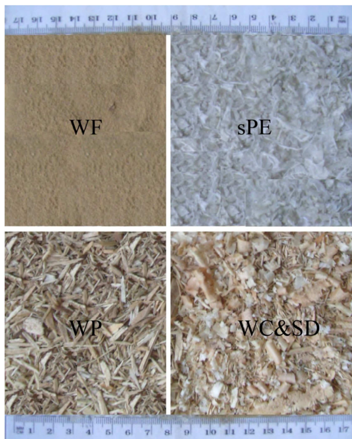
Slika 1. Polietilen (sPE) i punila (WF-drveno brašno; WP-drveno iverje; WC+SD-sječka+piljevina) (Izvor: Lyutty i sur., 2014)
