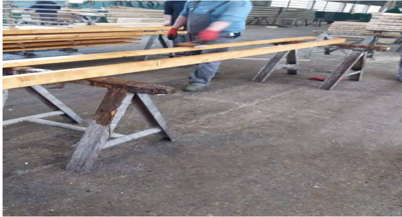
Slika 26. Nanošenje boje na lamelirano drvo
