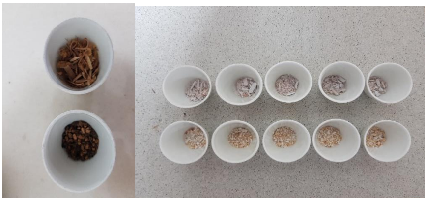
Slika 32. Uzorci vinove loze (gore) i maslinove komine (dolje) prije žarenja (lijevo) i nakon žarenja (desno)
