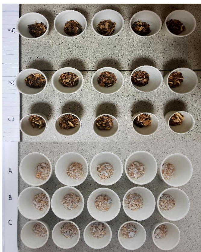
Slika 33. Uzorci mješavina A, B i C prije žarenja (gore) i nakon žarenja (dolje)
