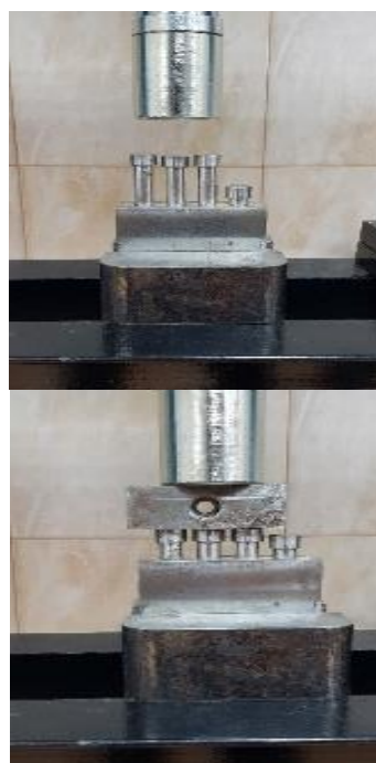
Slika 36. Prešanje uzoraka u tablete
