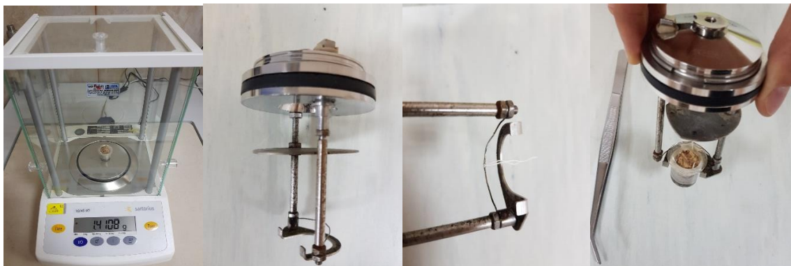
Slika 40. Početak pripreme kalorimetske bombe (priprema i postavljanje tablete)
