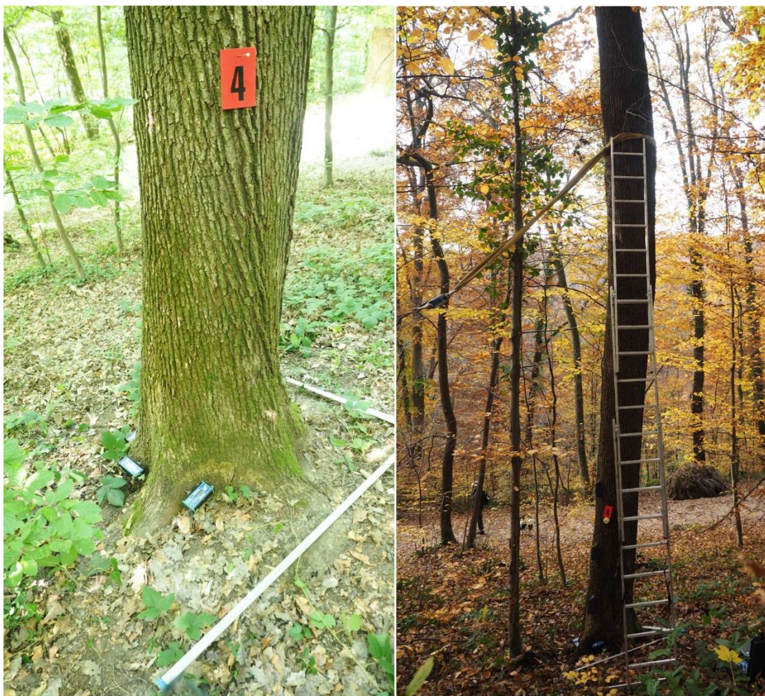
Slika 9. Postavljenje poteznog testa za izmjeru stabilnosti stabla
