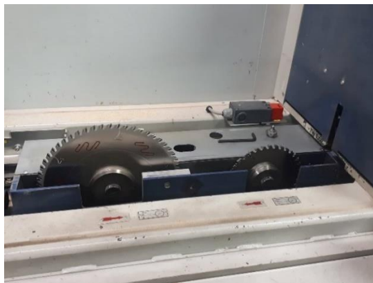
Slika 13. Predrezač i glavna pila za krojenje elemenata
