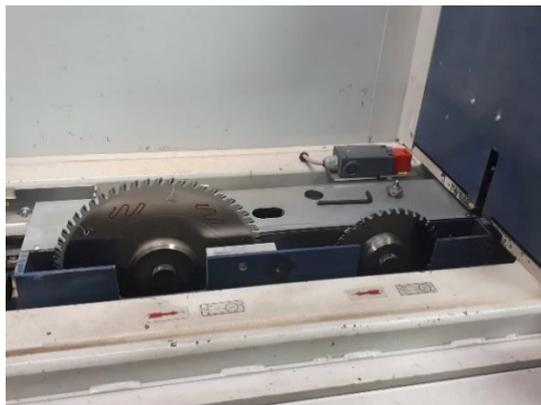
Slika 13. Predrezač i glavna pila za krojenje elemenata
