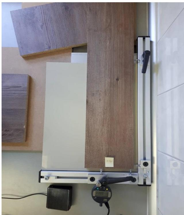
**Slika 15. Mjerni alat za mjerenje pravokutnosti**
