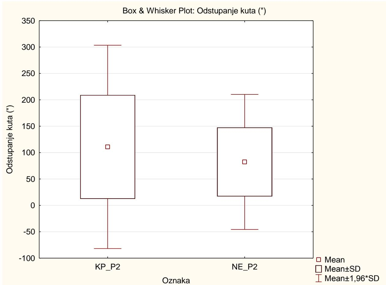
**Slika 33. Analiza razlika krojenja kružnom pilom i nestingom na panelu 2****Tabela 11. rezultati odstupanja vrijednosti dimenzija od traženih širina elemenata na panelu 3**
