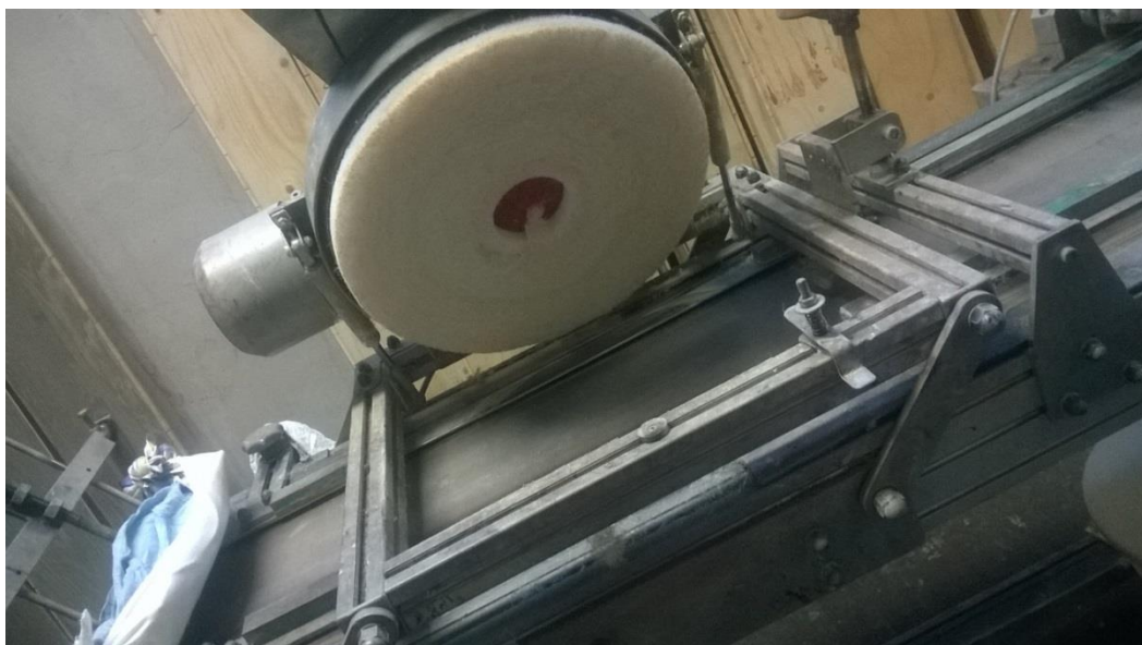
Slika 28. Filc koji razmazuje ulje po površini ploče tako što se rotira.
