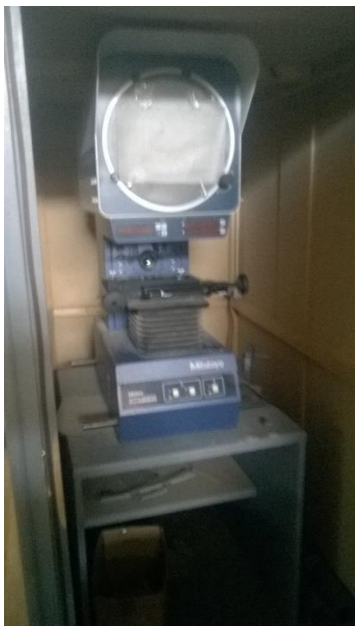
Slika 24. Grafoskop za kontrolu kvalitete u izradi profila
