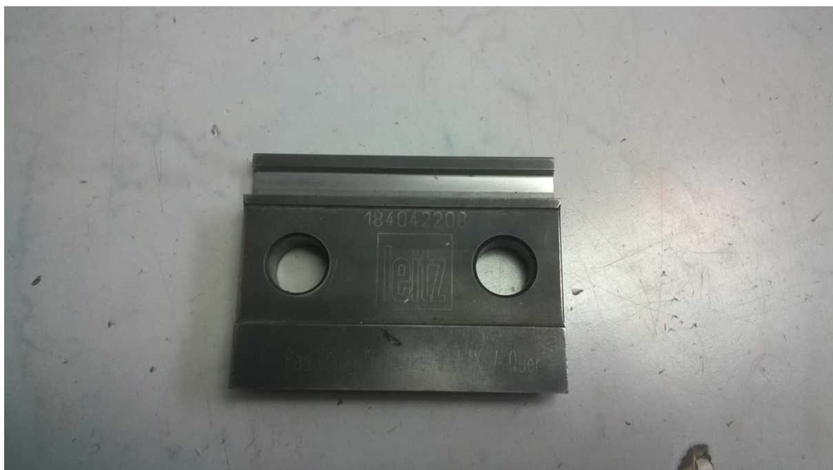
Slika 30. Kontrolna šablona za profile.
