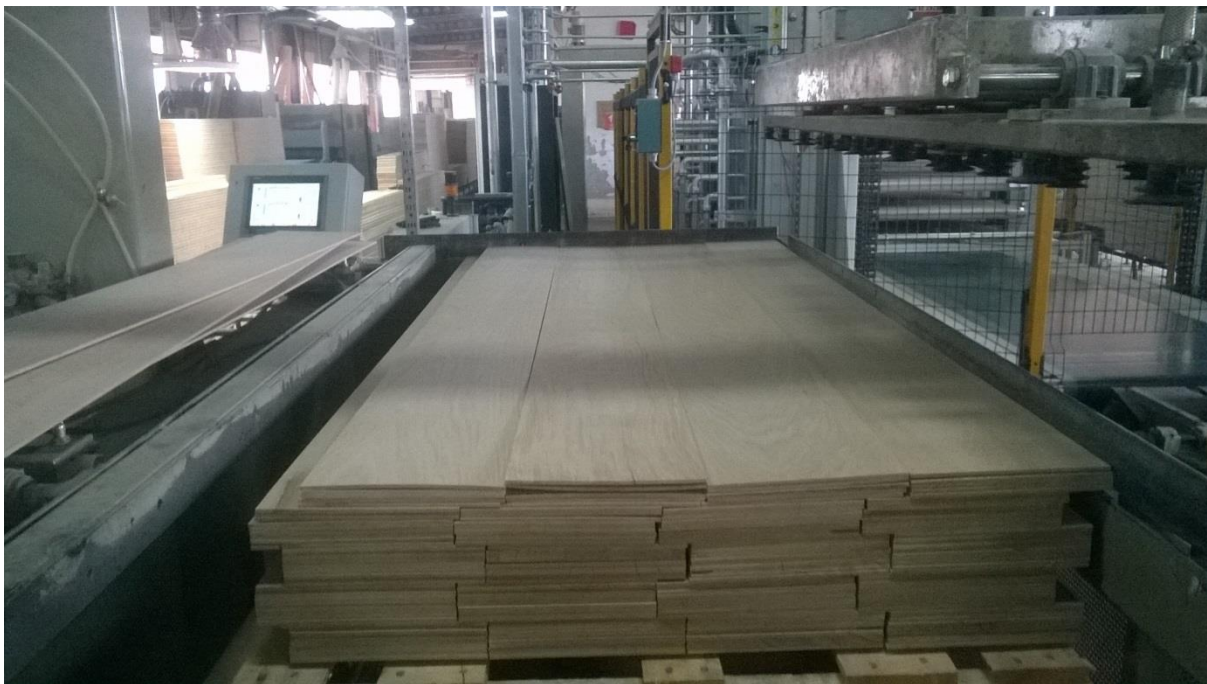
Slika 13. Priprema lica (1 strip) prije ulaska u prešu.
