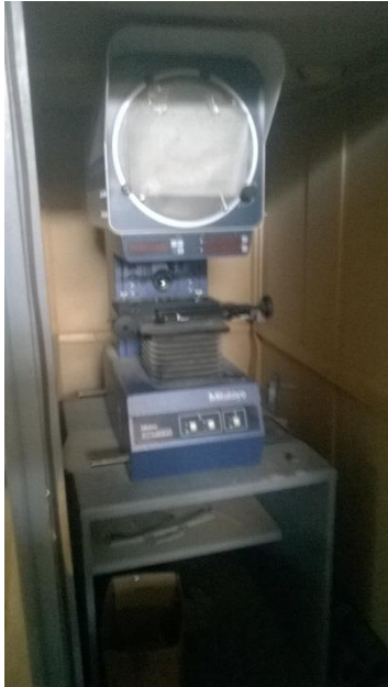
Slika 24. Grafoskop za kontrolu kvalitete u izradi profila
