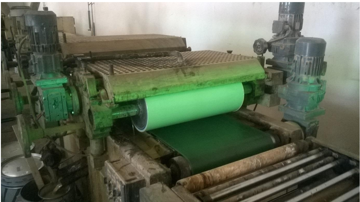
Slika 22. Gumeni valjak za nanošenje laka.
