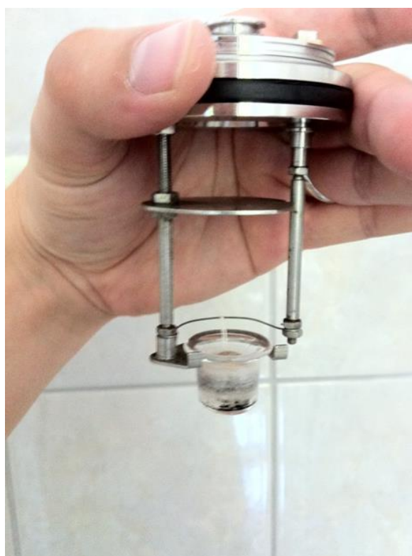
Slika 16. Detalj kalorimetarske bombe
