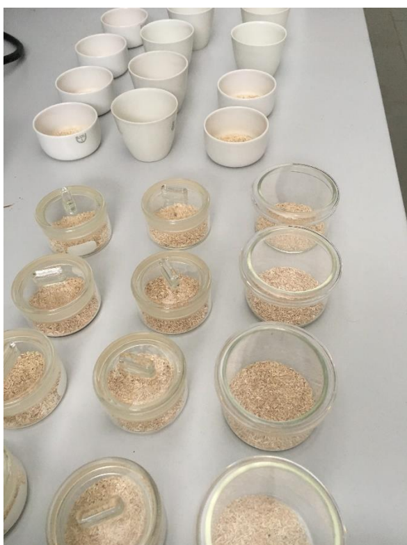
Slika 15. Analitički uzorci za određivanje udjela pepela i tehničkog masenog udjela vode
