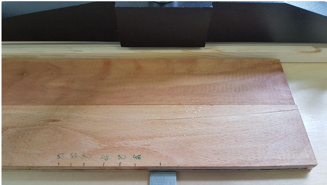
Slika 24 ispitivanje klizavosti pri utjecaju vode na površinu uzorka
