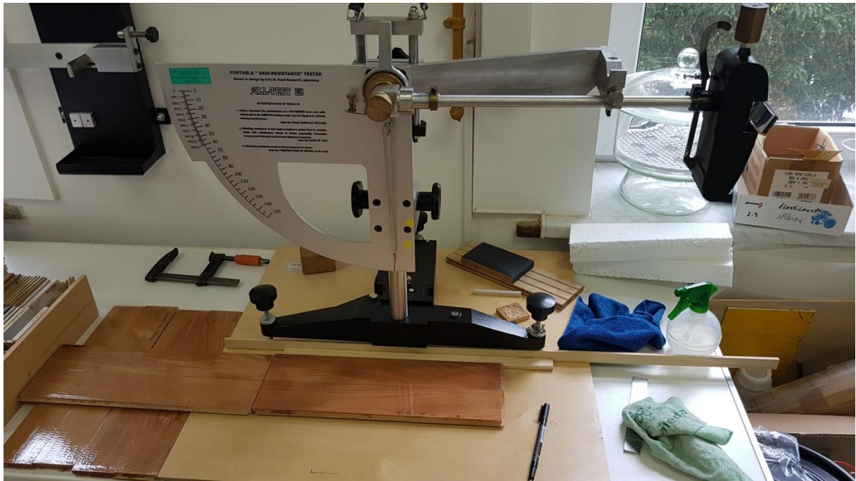
Slika 19. Njihalo za ispitivanje klizavosti
