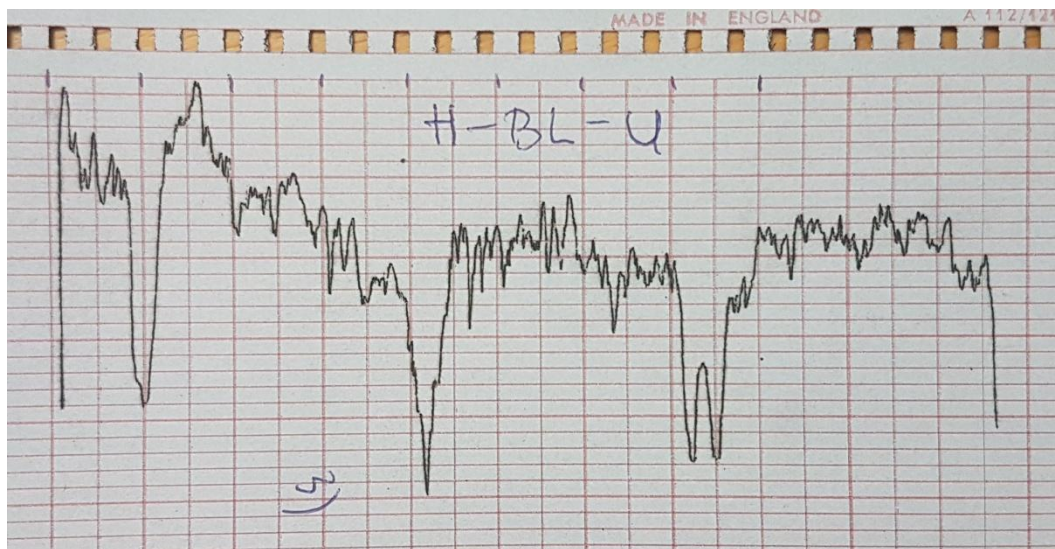
Slika 46 mjerenje hrapavosti na uzorku hrastovina-blistača-ulje
