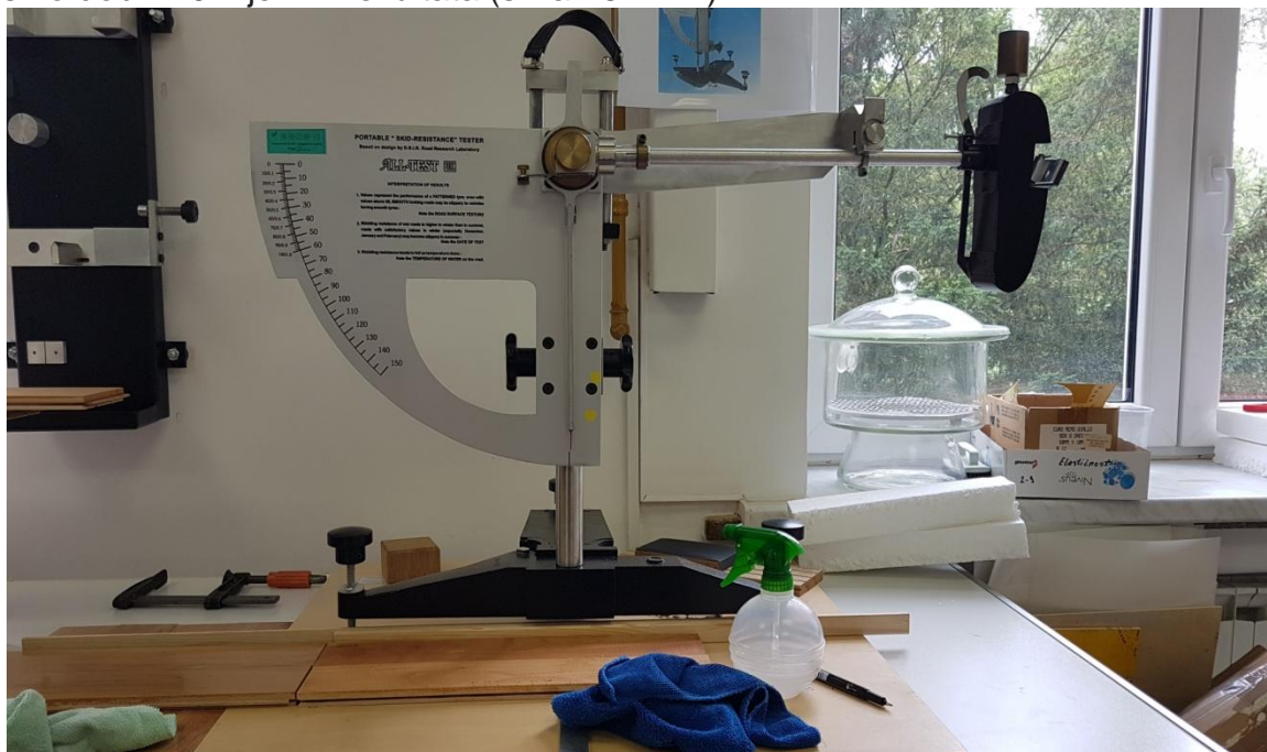
Slika 23 priprema ispitivanja klizavosti površine prilikom utjecaja vode
