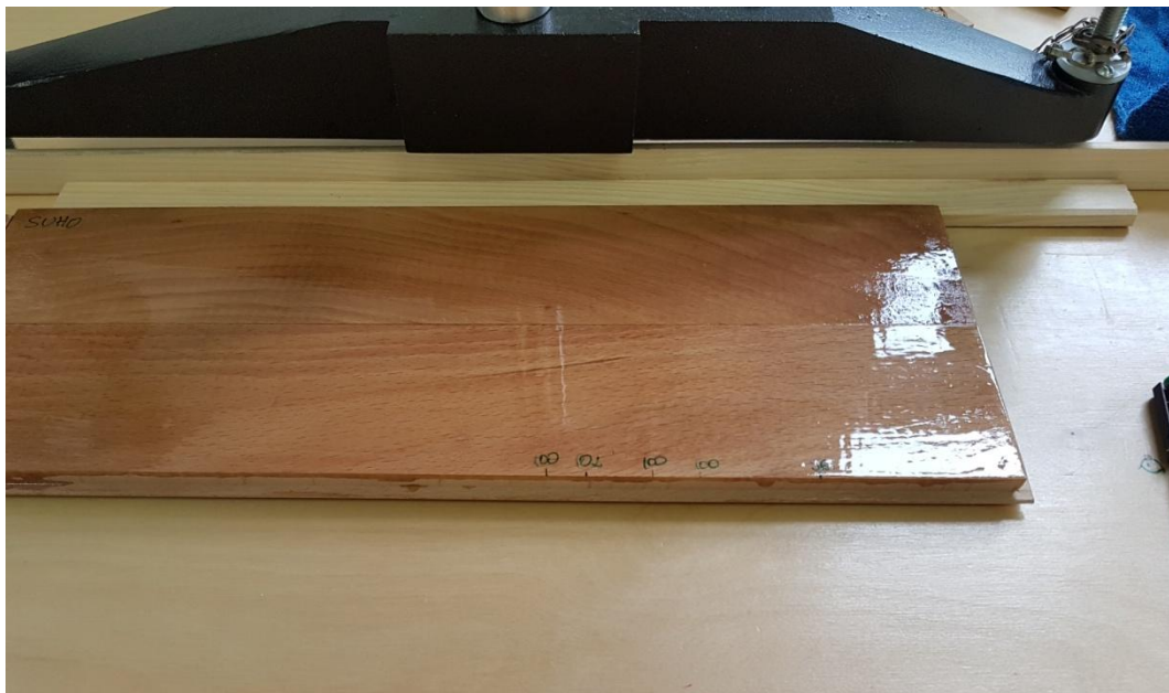
Slika 22 Ispitivanje klizavosti na "suho"
