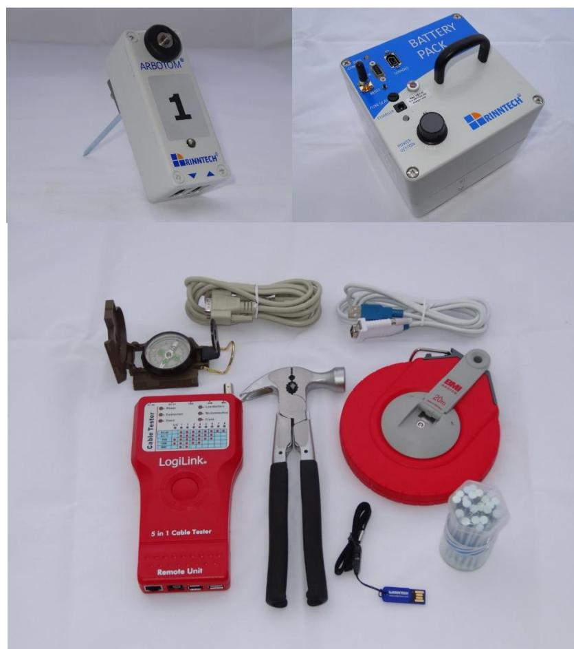
**Slika 8.** Prikaz dijelova zvučnog tomografa
