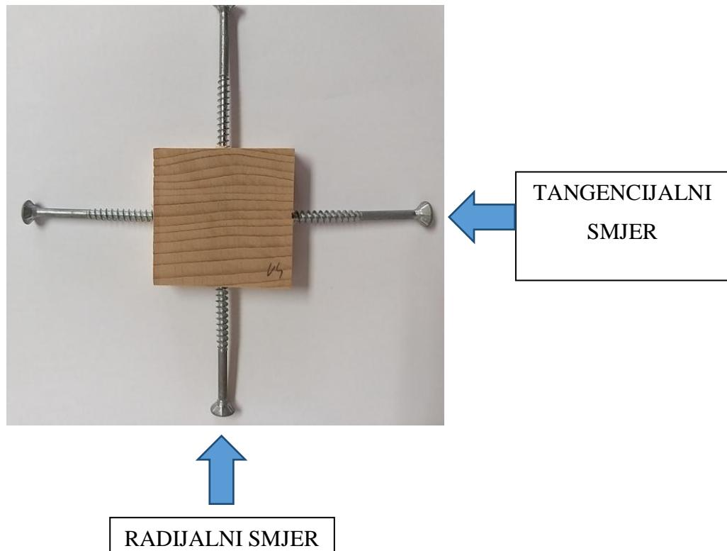
**Slika 10.** Prikaz uzorka za ispitivanje sa označenim smjerovima
