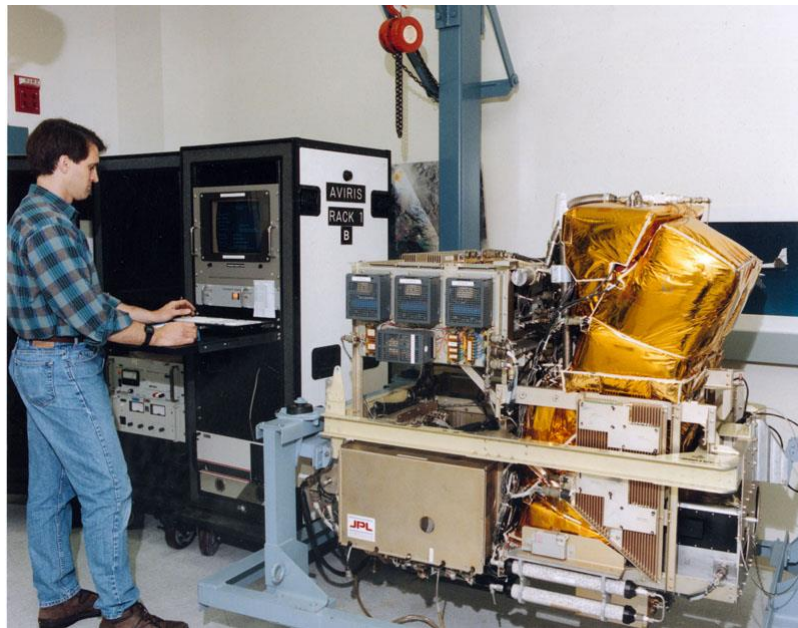
Slika 7.: AVIRIS hiperspektralni senzor ( https://www.nasa.gov/images/content/612114main_AVIRIS_checkout.jpg )
