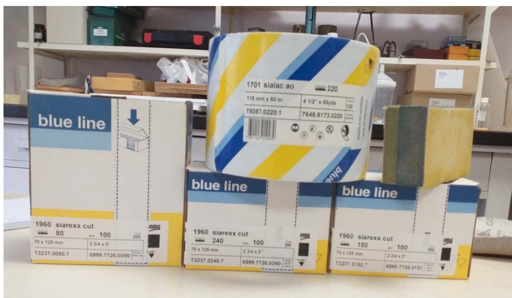
Slika 4. Brusni papiri korišteni za brušenje
