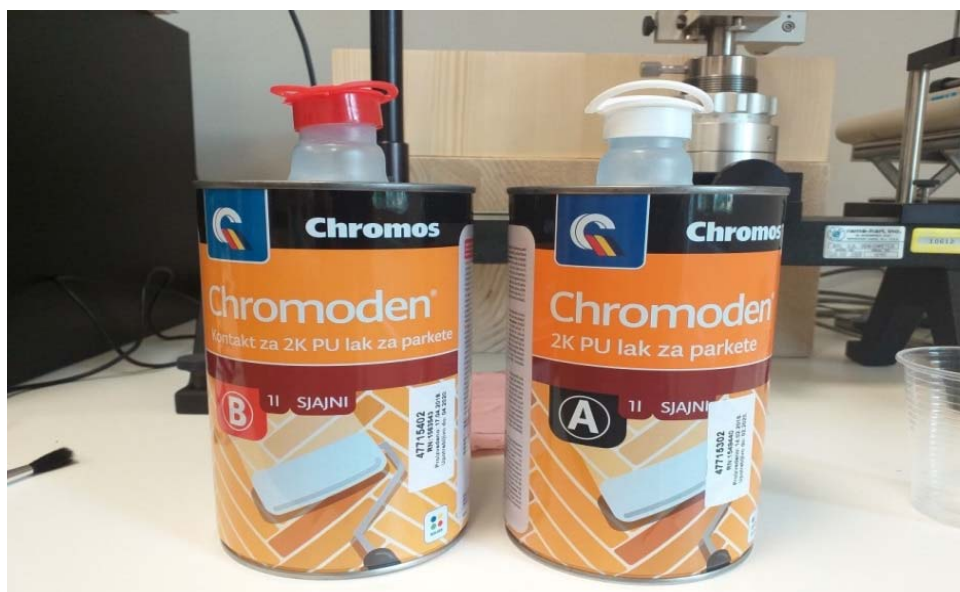
Slika 5. Komponenta A i B za dvokomponentni PU lak
