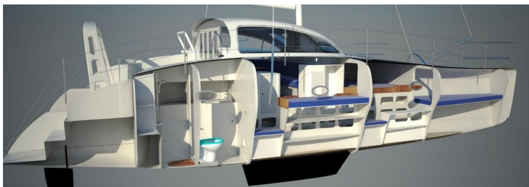
Slika 5. Prikaz podjele prostora u plovilu, 3D Izvor: web 5
