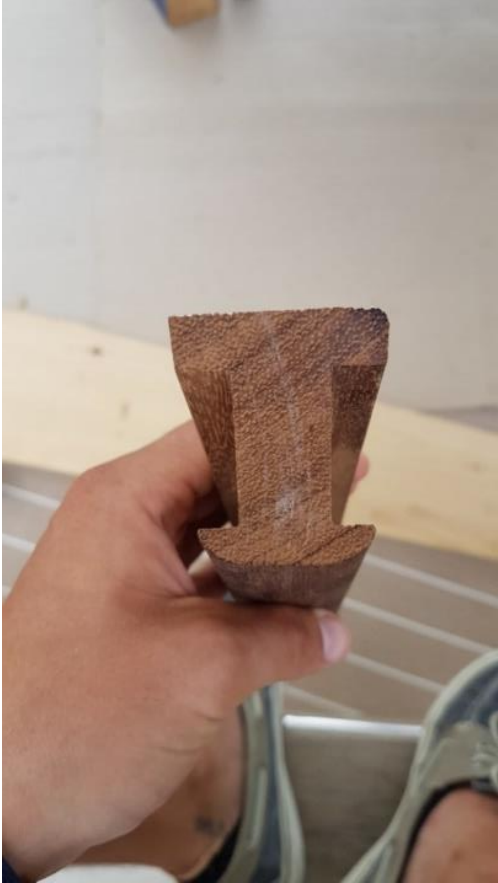
Slika 21. Drveni spojevi za plastične panele. Izvor: Pečarina, 2019.
