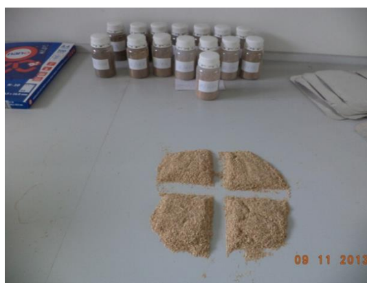
Slika 9. Priprema uzorka četvrtinskom metodom
