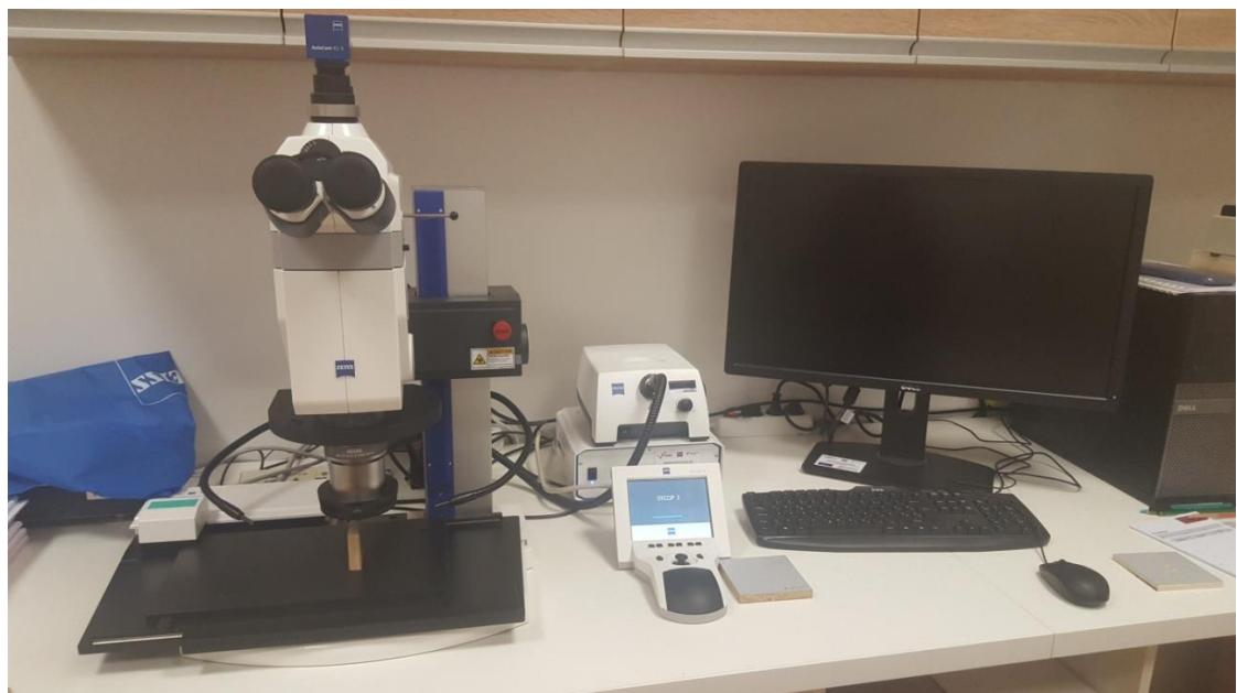
Slika 12. Mikroskop za mjerjenje suhe debljine filma premaza
