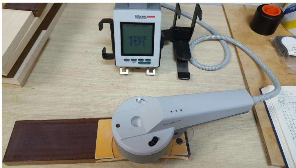
Slika 9. Spektralni fotometar Microflash 100d Datacolor i maska za mjerjenje
