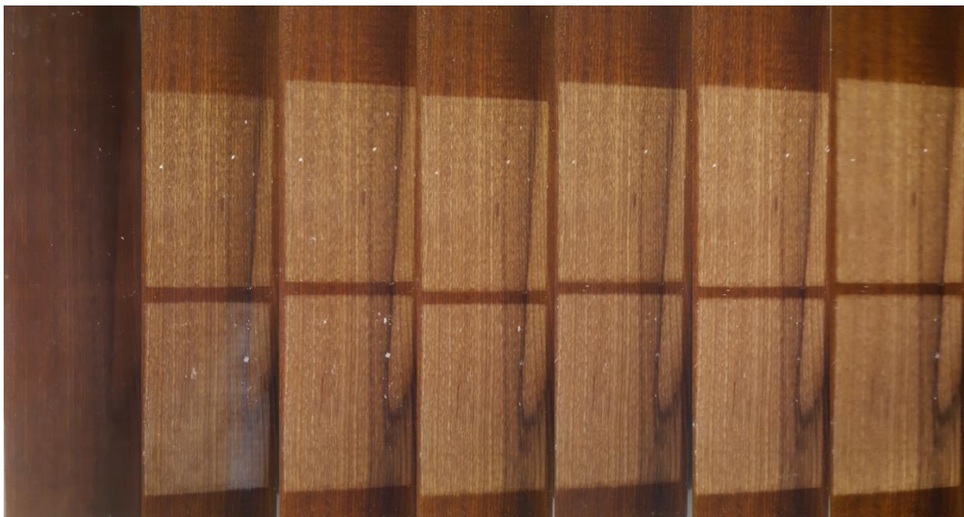
Slika 39. Uzorci T-F-1-2 (tijekom izlaganja od 1h, 168h, 336h, 504h, 672h, 840h, 1008h)
