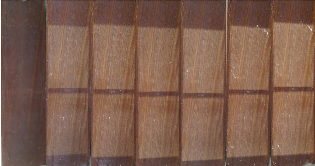
Slika 38. Uzorci T-E-1-2 (tijekom izlaganja od 1h, 168h, 336h, 504h, 672h, 840h, 1008h)
