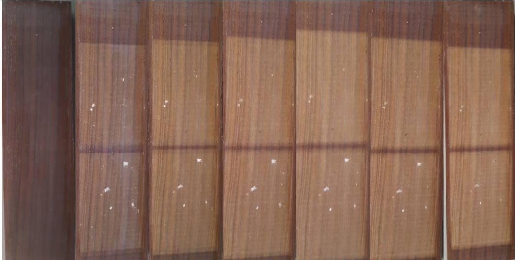
Slika 42. Uzorci T-I-1-2 (tijekom izlaganja od 1h, 168h, 336h, 504h, 672h, 840h, 1008h)
