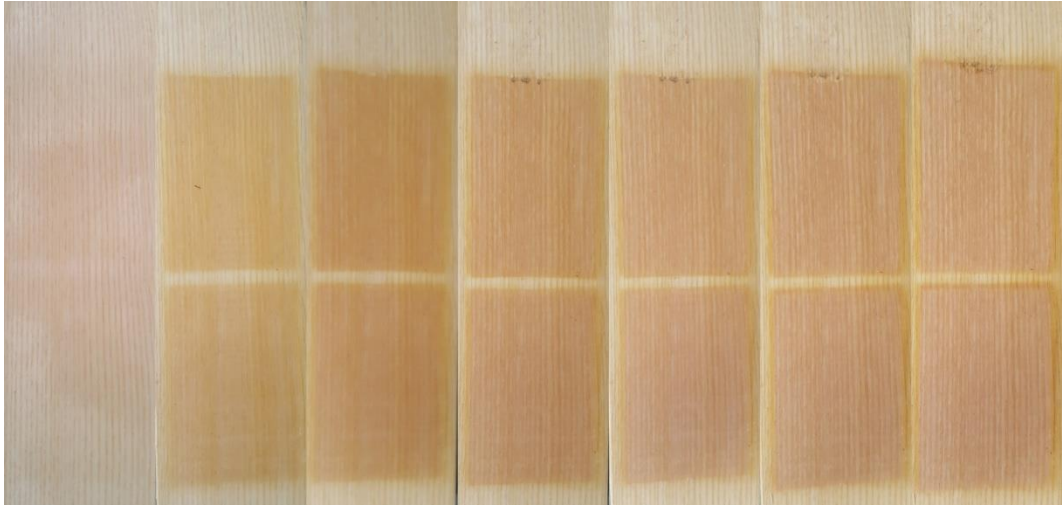
Slika 51. Uzorci N-I-1-2 (tijekom izlaganja 1h, 168h, 336h, 504h, 672h, 840h, 1008h)
