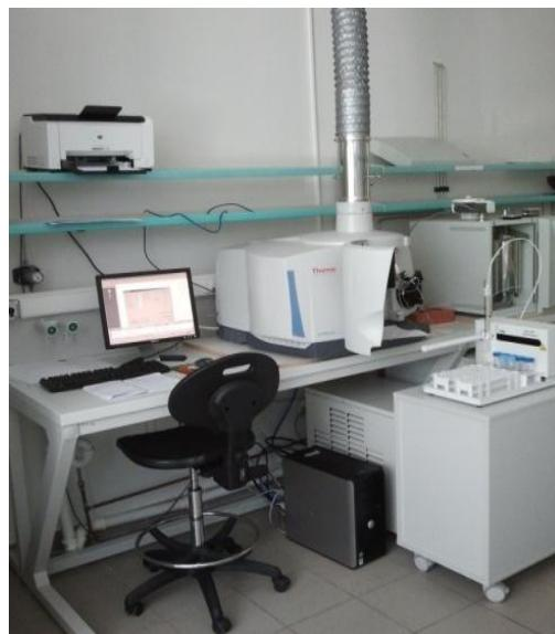
**Slika 3.** Spektrometar Thermo Fischer iCAP6300 Duo
