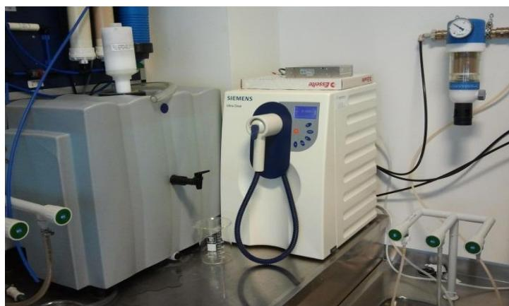
**Slika 2.** Uređaj za pripravu ultračiste vode Siemens Ultraclear
