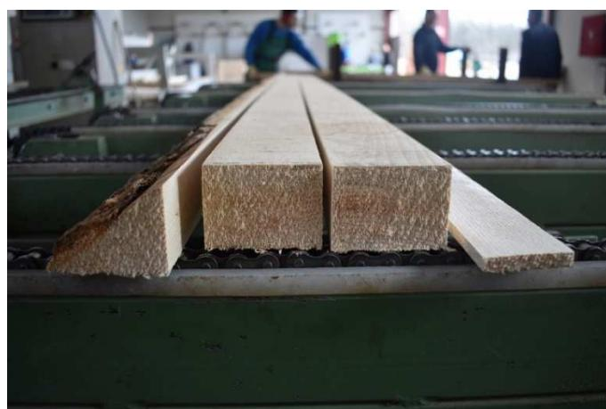
*Slika 4. Jasenove gredice raspiljene na višelisnoj kružnoj pili.*
