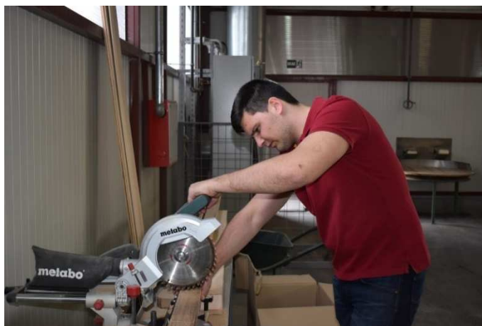
Slika 8. Izrada konačnih uzoraka pomoću potezne kružne pile.
