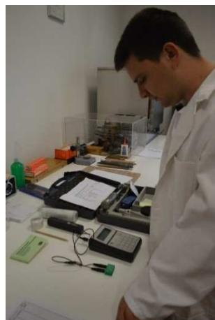
Slika 17. Kalibracija vlagomjera.
