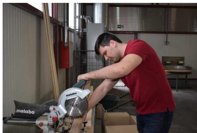
*Slika 8. Izrada konačnih uzoraka pomoću potezne kružne pile.*
