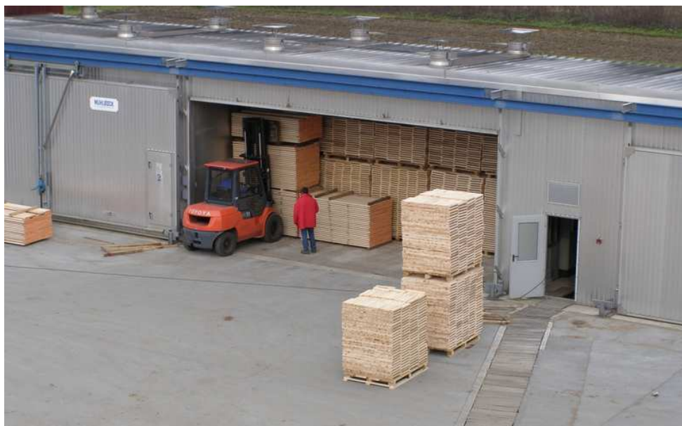
Slika 1. Prikaz komorne sušionice.
