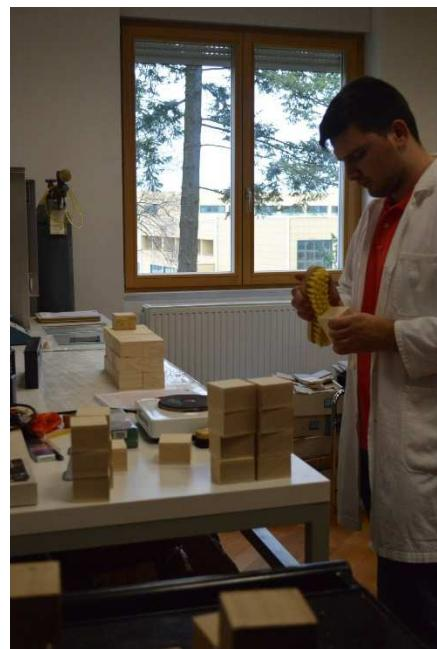
*Slika 12. Čišćenje uzorka od iverja.*
