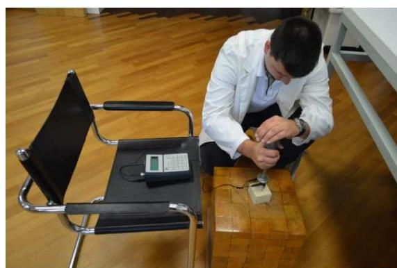
Slika 18. Zabijanje sondi elektrootpornog vlagomjera u uzorak.
