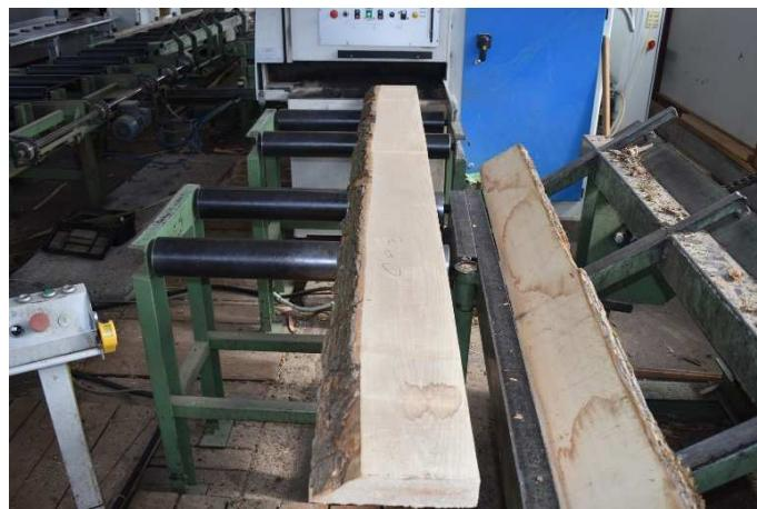
*Slika 3. Raspiljivanje jasenovih piljenica na višelisnoj kružnoj pili.*
