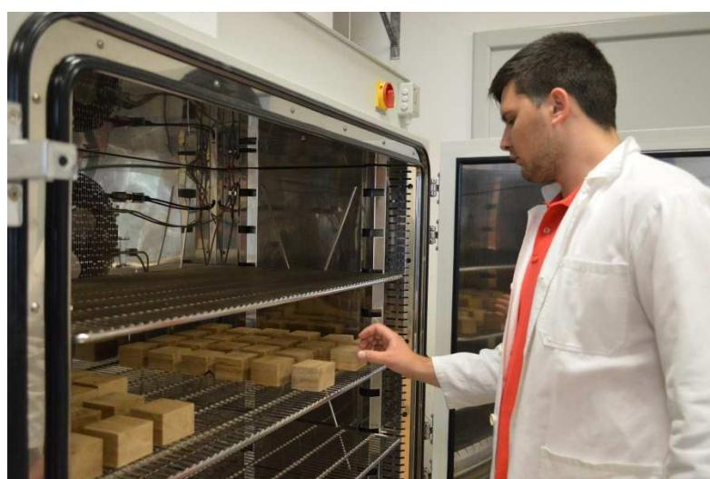
Slika 16. Slaganje uzorka u klimatizacijsku komoru.
