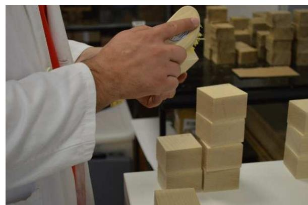
*Slika 13. Čišćenje uzorka pomoću četke.*
