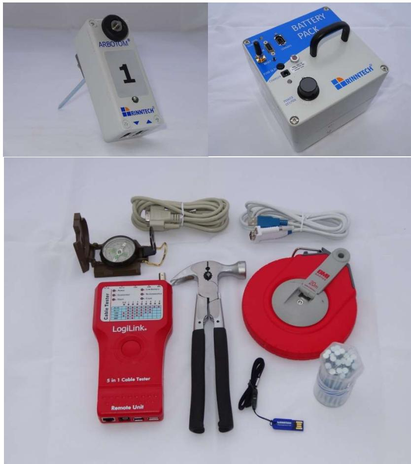
Slika 8. Prikaz dijelova zvučnog tomografa
