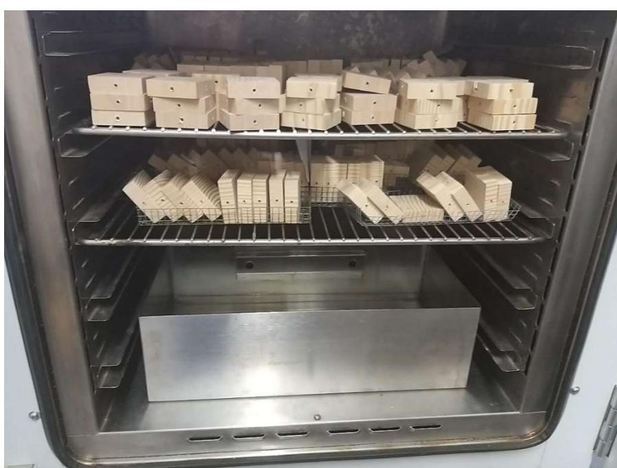
*Slika 6. Sušionik s uzorcima koji je ujedno služio i kao klima komora za kondicioniranje uzorka*
