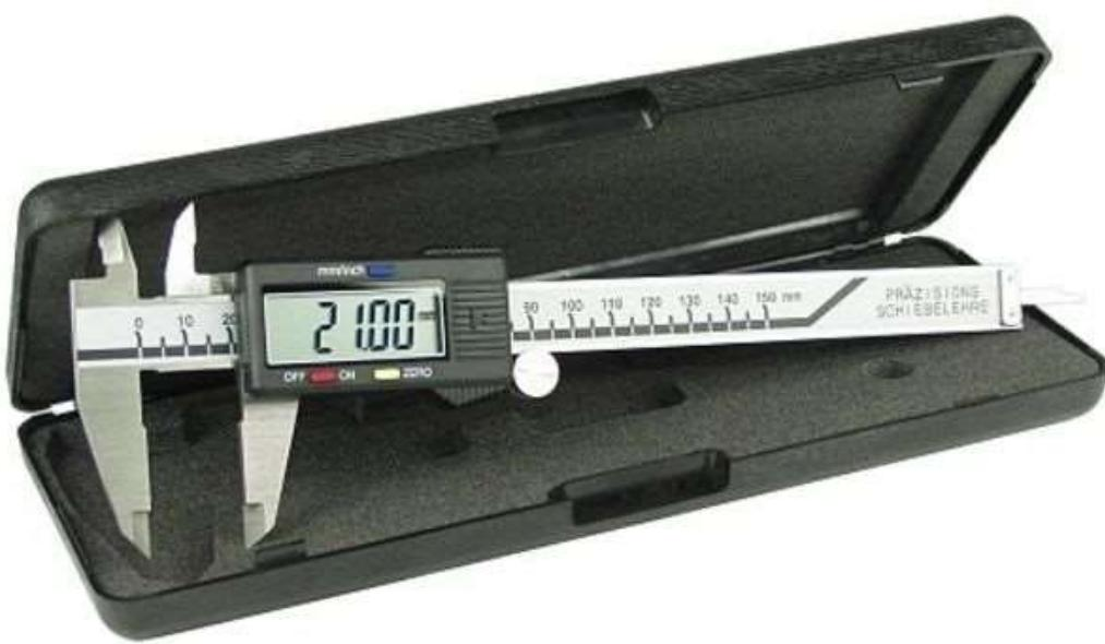
Slika 4. Prikaz pomičnog mjerila
