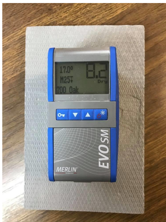
Slika 8. Očitanje procijenjenog sadržaja vode pomoću kapacitativnog uređaja Merlin EVO SM.
