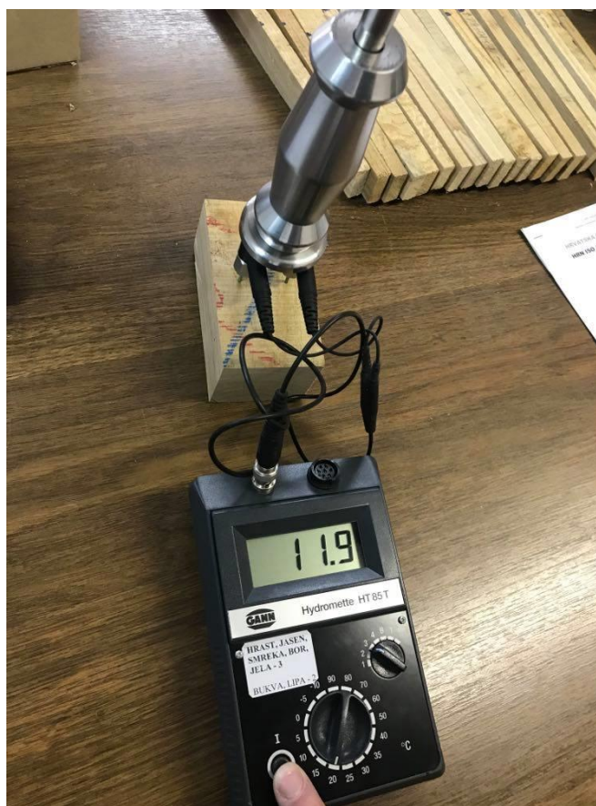
Slika 7. Očitavanje procijenjenog sadržaja vode pomoću elektrotopnog uređaja GANN Hydromette HT 85 T.
