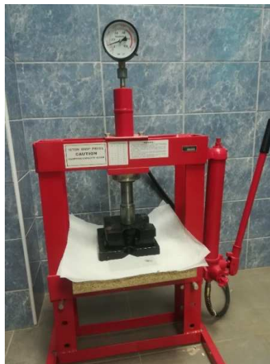
Slika 7. Postupak hladnog prešanja
