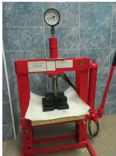
Slika 7. Postupak hladnog prešanja
