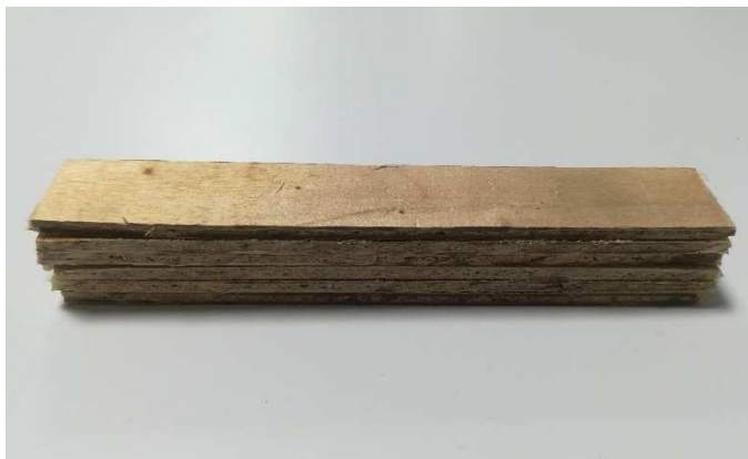
Slika 8. Uzorci za ispitivanje savojne čvrstoće i modula elastičnosti
