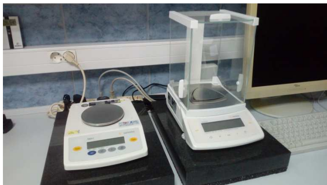
Slika 5. Laboratorijske vage Sartorius TE 612-L i CPA 225D-0CE
