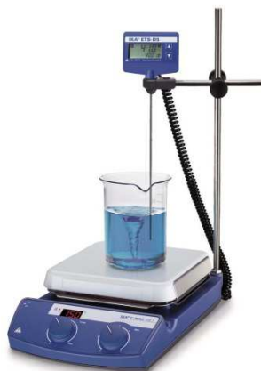
Slika 6. Elektromagnetska miješalica IKA C-MAG HS 7
