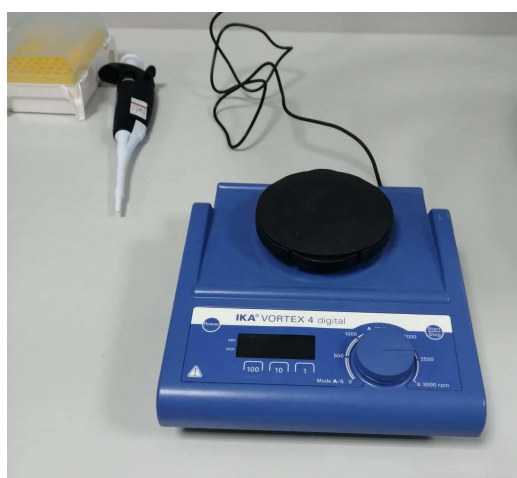
Slika 8. Laboratorijska mješalica IKA VORTEX 4 digital
