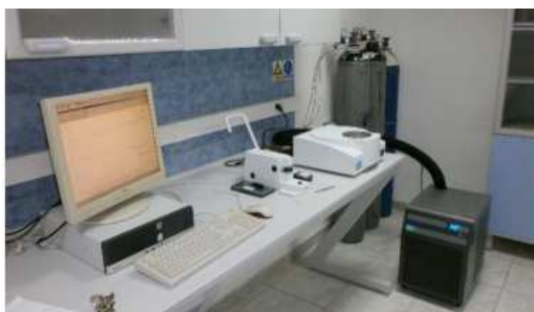
Slika 7. Diferencijalni skenirajući kalorimetar (DSC)
