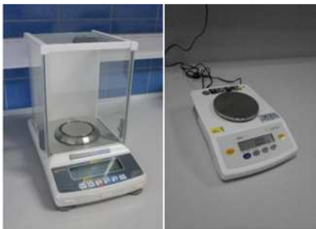
Slika 2. Laboratorijska vaga Sartorius TE 612-L i analitička vaga KERN ABT 220-4M
