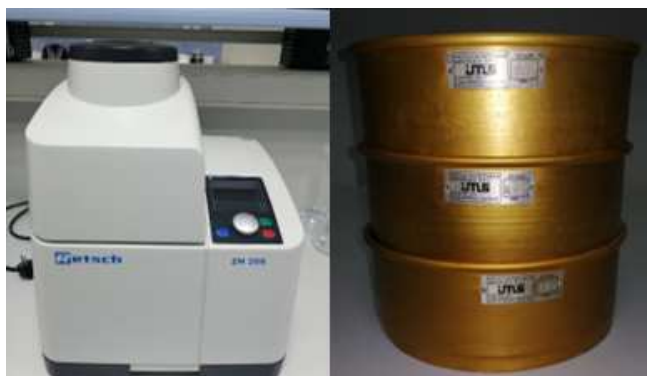
Slika 1. Mlin Retsch SM 300 i korištena sita
