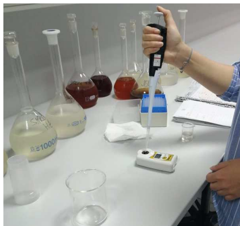
Slika 9. Refraktometar ATAGO Pal- \alpha
