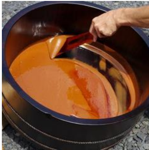
Slika 12. Tradicionalni postupak rafiniranja urushia „ Kurome “ (KOGEI STYLING, 18/8/2020, url)
