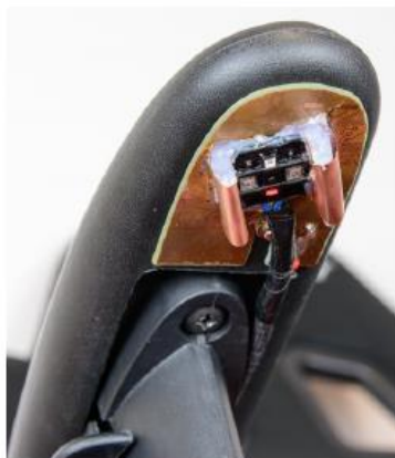
Slika 27. Prikaz PPG senzora u rukonaslonu pokusne stolice
