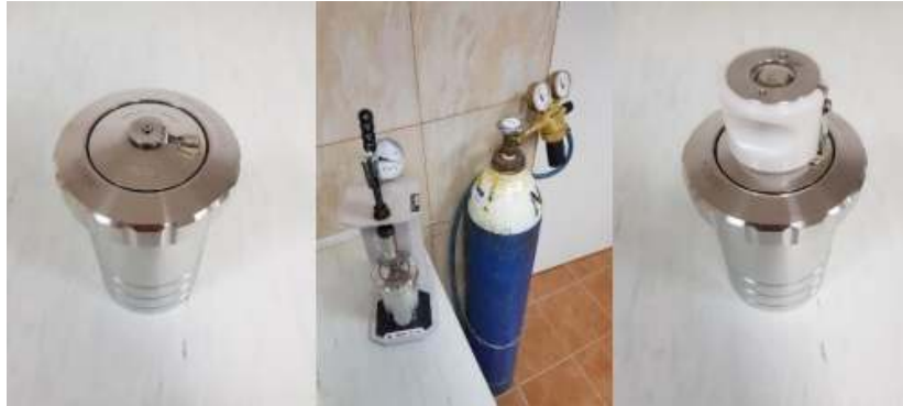
Slika 11: Zatvaranje kalorimetarske bombe i punjenje kisikom
