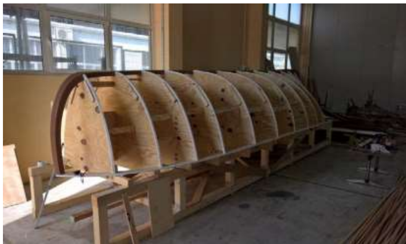
Slika 25. Kalup za izradu gajete
