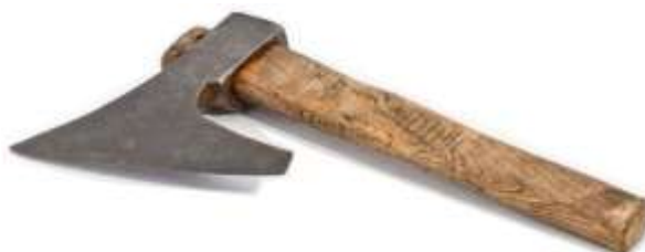
Slika 4. „Bradva“- tesarska sjekira lijevo svinute drške za tesanje manje dostupnih dijelova, kojom se oblikuju zakrivljeni dijelovi broda.
