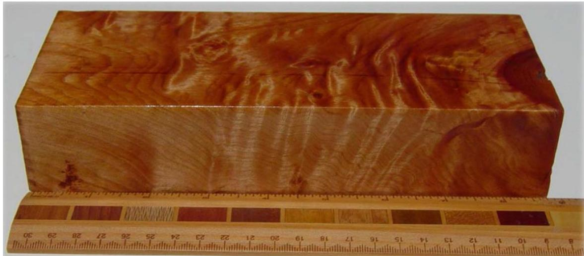
*Slika 13. Uzorak južne bukve nakon sušenja (izvor: VacDryKilns, 15.8.2020.)*
