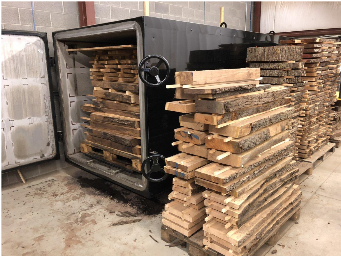
Slika 8. Sušenje cirkulacijom zagrijanog zraka (izvor: https://idrywood.com/idry-standard , 15.8.2020.)
