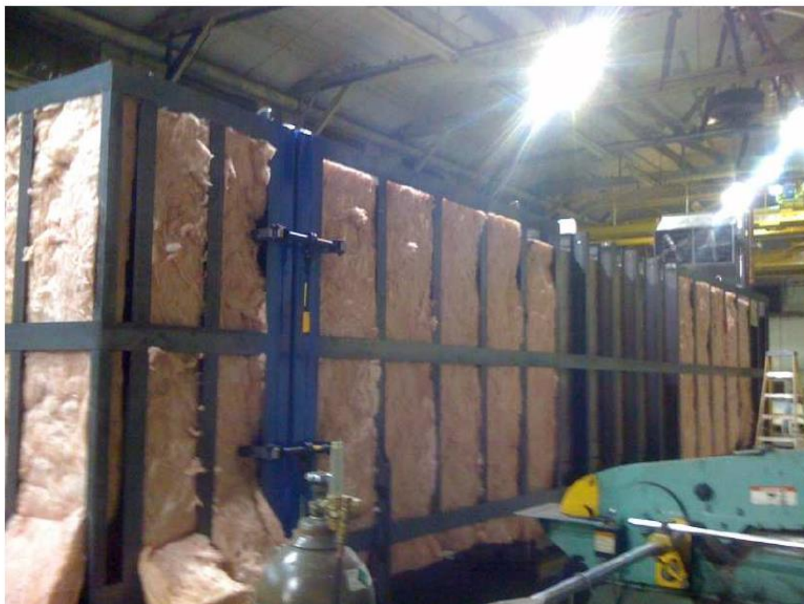
Slika 10. Izolacija komore (izvor: Parker, J., Vacuum lumber drying).
