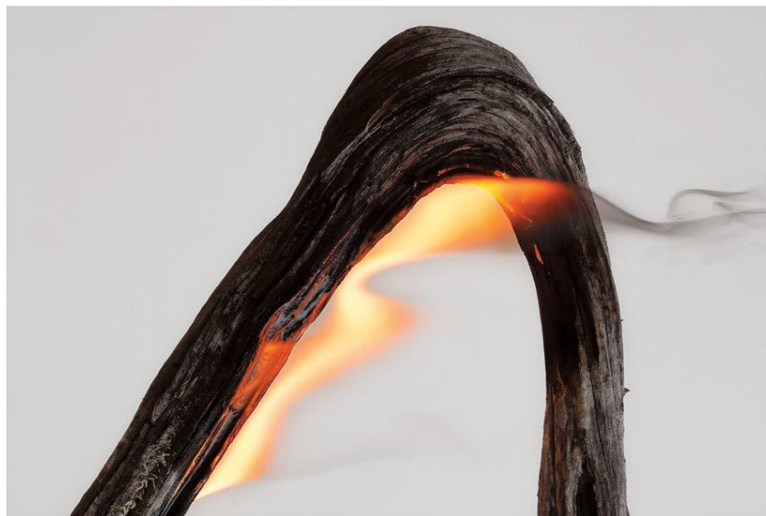
Slika 6: "Shou sugi ban" pougljenjivanje japanskog cedra
